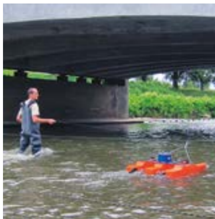
Messtechniker bei einer Durchflussmessung mit ADCP-Boot
