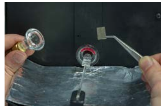
Bestückung eines Ruß-Analysators mit einem Luftstaubfilter
