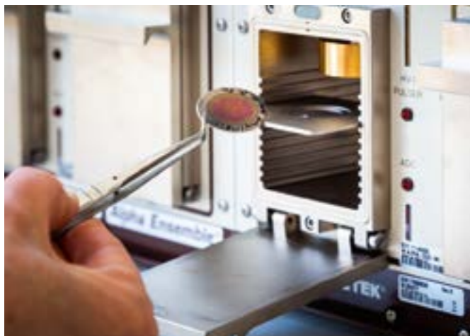
Messpräparat zur Alphaspektrometrie
