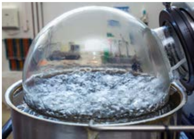
Rotationsverdampfer zum Einengen großvolumiger Proben
