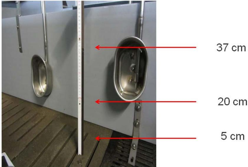
**Abbildung 4: Der Pegelstand der Gülle (37 cm) und Befestigungspunkte der Messsensoren für die Messung der Gülletemperatur am Metallstab.**
