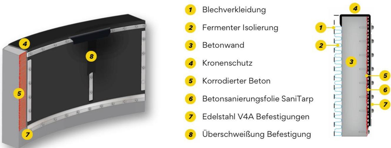
**Abbildung 28: Schematischer Aufbau eines Foliensystems nach /20/**
