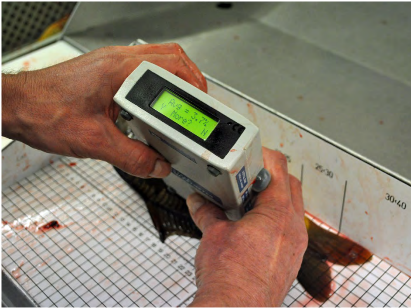
Abbildung 16: Untersuchungen zur Produktqualität von Speisekarpfen – Hier Fettbestimmung mit dem Distell-Fettmessgerät
