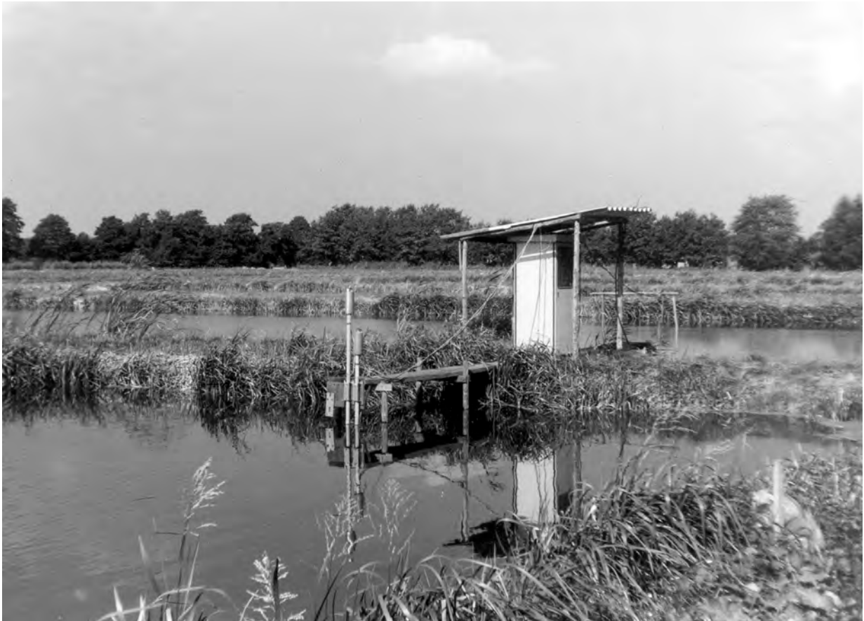
Erste Mess- und Regelungstechnik in der VTA Königwartha für die Erfassung der Sauerstoff-, pH- und Temperaturwerte sowie für die Steuerung der Belüftungstechnik
