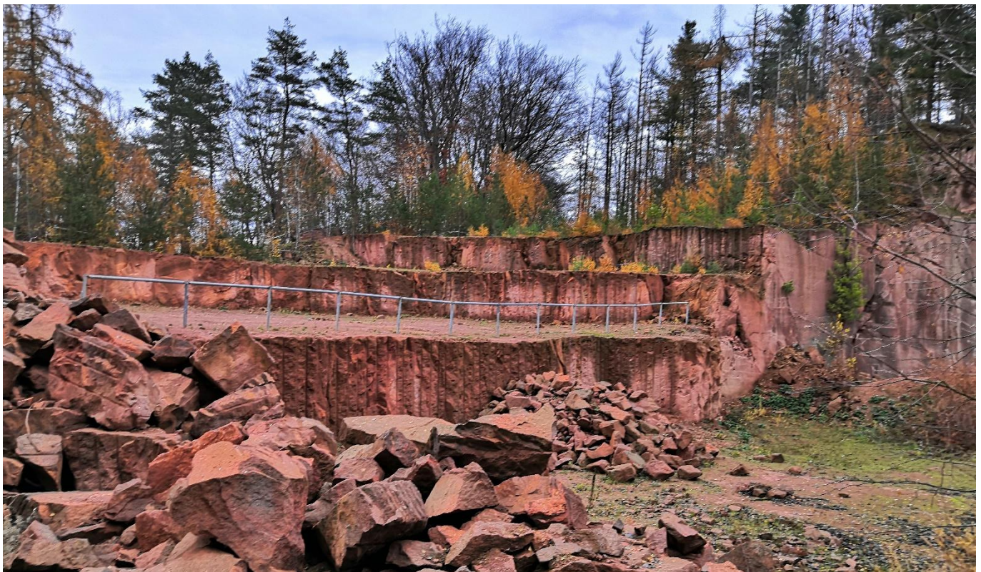
Abbildung 4: Rochlitzer Porphyrtuff als Baustoff (Steinbruch am Rochlitzer Berg südwestlich von Rochlitz).
