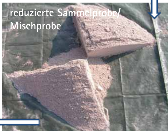
Schema zur Bildung der reduzierten Sammelprobe/ Mischprobe und der drei Endproben durch zufällige Teilmengenentnahme (Fotos: BfUL)
