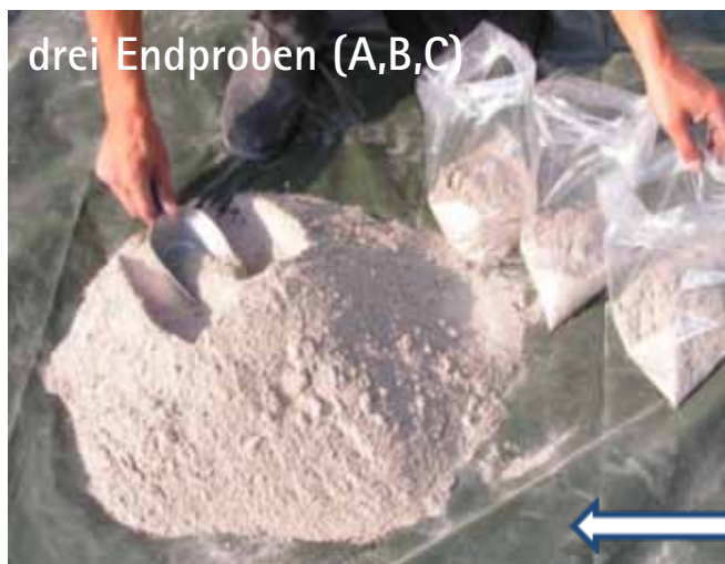
Schema zur Bildung der reduzierten Sammelprobe/ Mischprobe und der drei Endproben durch zufällige Teilmengenentnahme (Fotos: BfUL)
