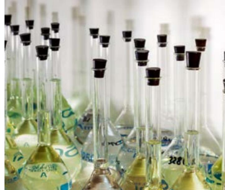
Abb. 10: Lösungen zur Bestimmung der Schwermetallgehalte
