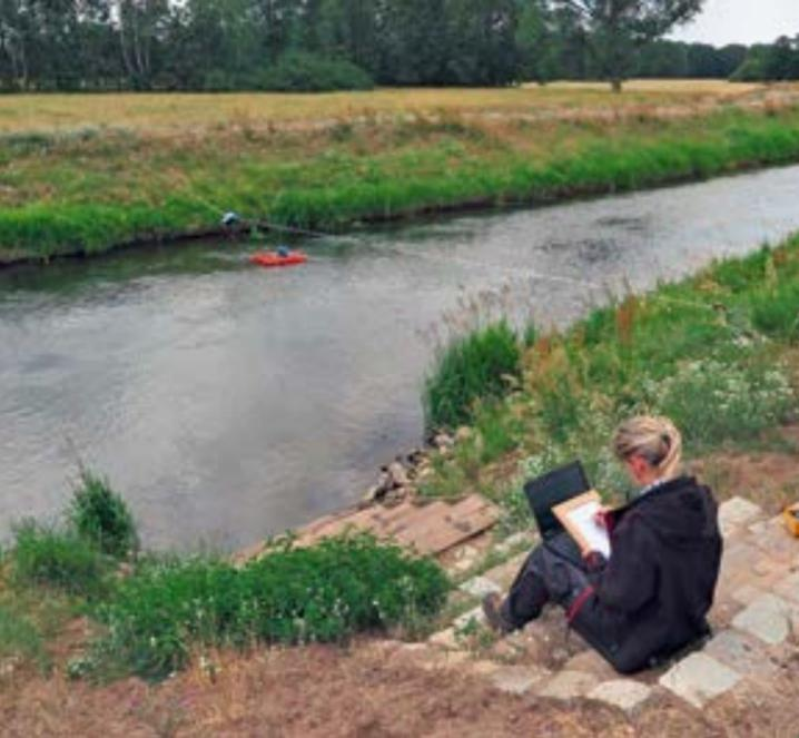
Abb. 12: Durchflussmessung der Hauptspreewald im Spreewald im Rahmen einer Stichtagsmessung
