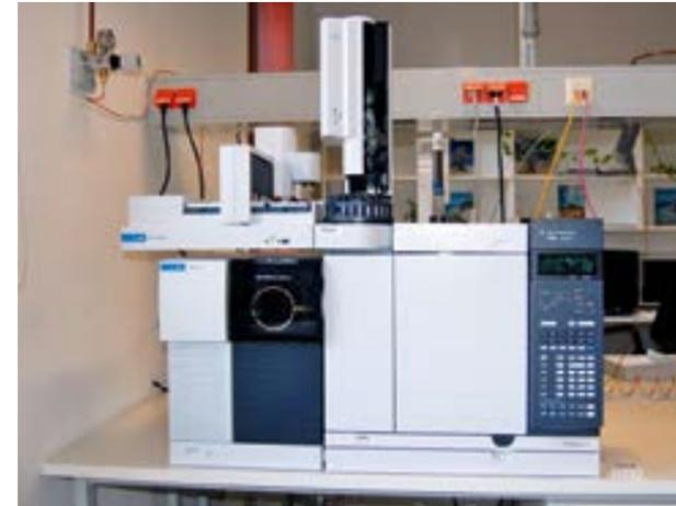
Abb. 19: Gaschromatograph mit Tripelquadrupol Massenspektrometer (GC/MS/MS)
