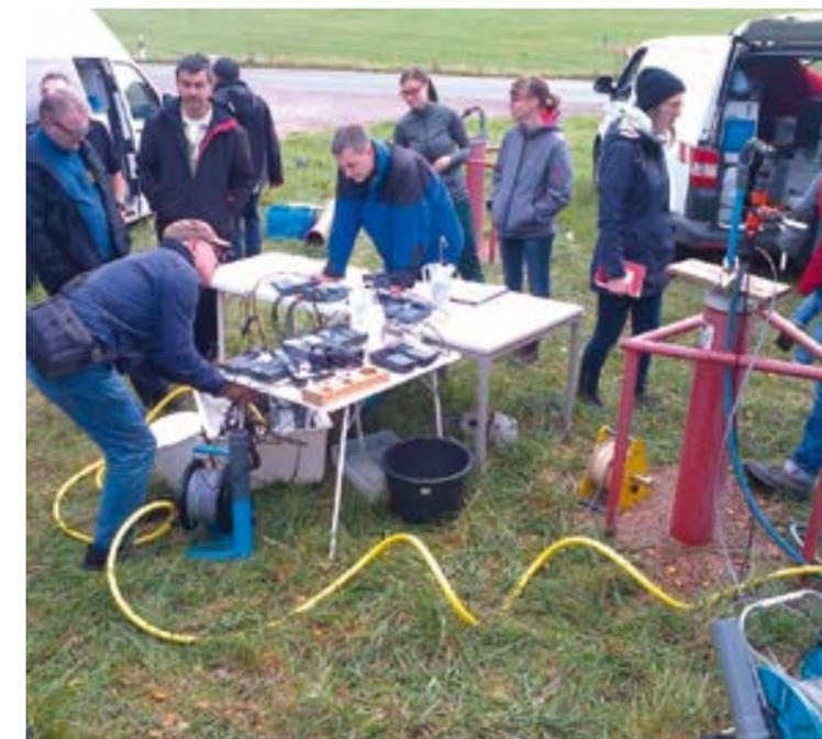
Abb. 13: Länderübergreifende Vergleichsprobennahme an einer Grundwassermessstelle bei Crimmitschau
