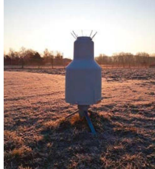
Abb. 11: Montage des Prototyp für die automatische Probenahme an BDF-II-Flächen
