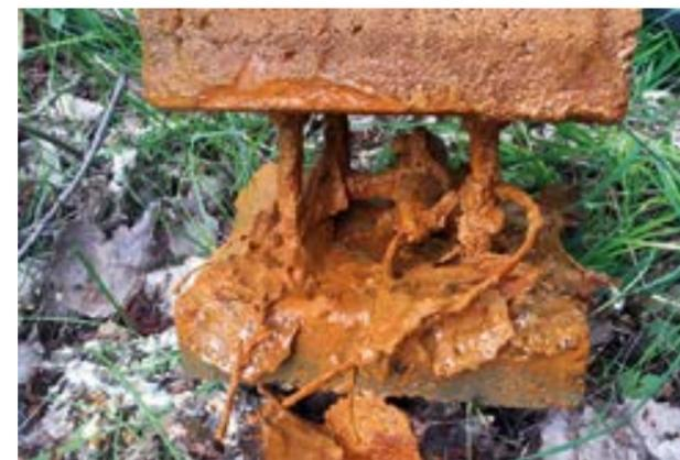
Abb. 15: Eisenverkrusteter Datenlogger
