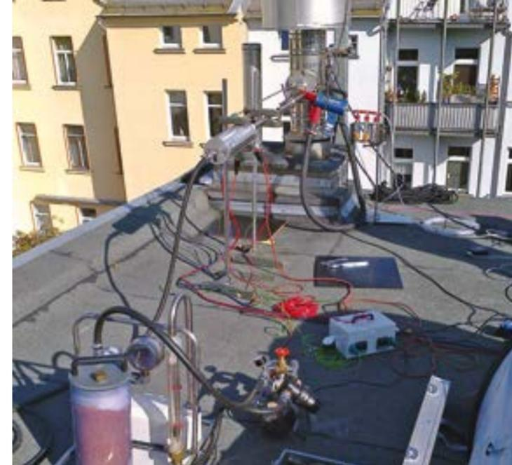
Abb. 12: Ringversuch zum Staub an der ESA (Emissions-Simulations-Anlage) des Hessischen Landesamtes für Naturschutz, Umwelt und Geologie in Kassel
