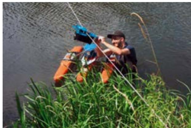
Abb. 2: Messtechniker bei einer Durchflussmessung mit mobilem Seilkran und ADCP
