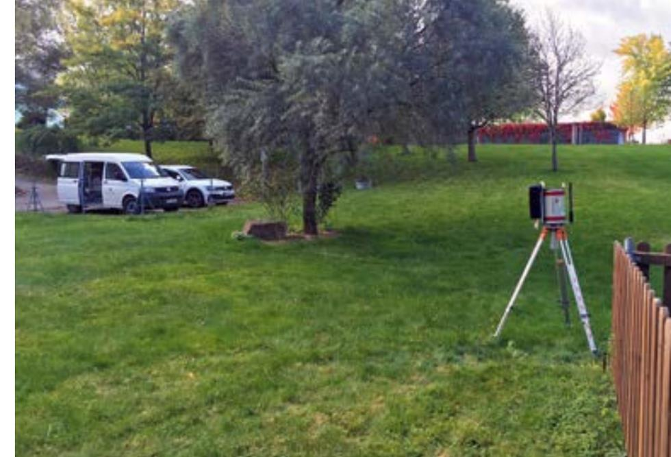
Abb. 3: In-situ-gammaspektrometrische Messung in Bad Schlema während der IMIS-Übung im Oktober 2019
