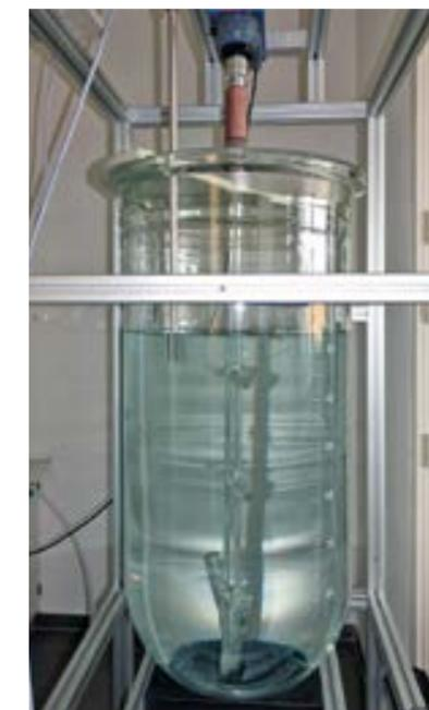
Abb. 21: Rührgefäß für Probenvorbereitung LÜRV55 (BSB)
