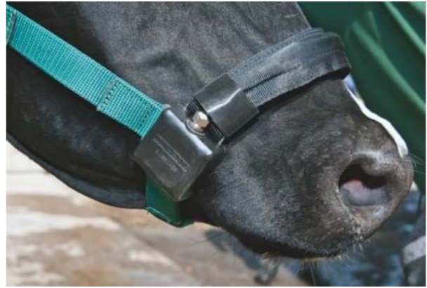
Abbildung 2: Sitz des Druckschlauches auf der Nase bei angelegtem RW-Messhalter (Quelle: ITIN+HOCH)
