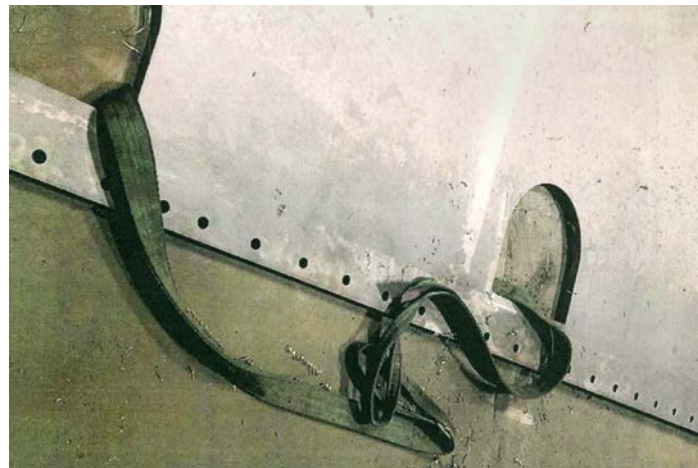
2.3.3 / Abbildung 1: Hebeband vor dem Anheben der Last ohne Kantenschoner (nachgestellte Aufnahme)
