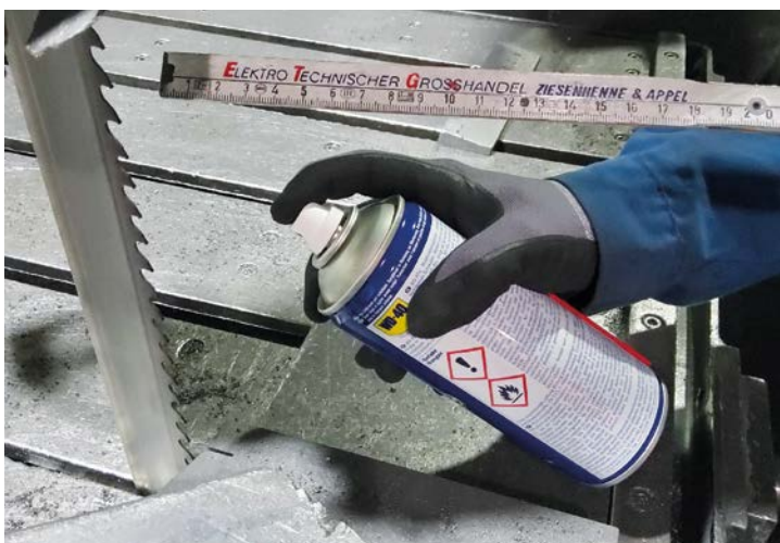
2.3.2 / Abbildung 1: schematisch nachgestellte Situation des Aufsprühens des Flussmittels an der Säge
