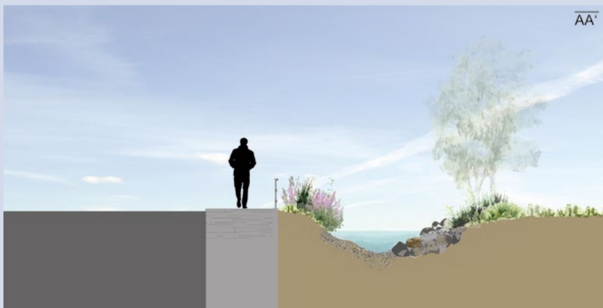
Gestaltungsmöglichkeit für einen Bach mit schmalen Gewässerkorridor (Querschnitt)
