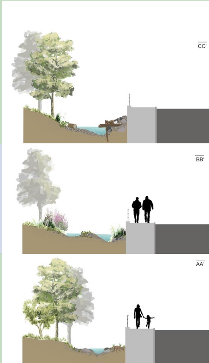
Gestaltungsmöglichkeit für einen Bach mit einseitiger Begrenzung (Querschnitt)
