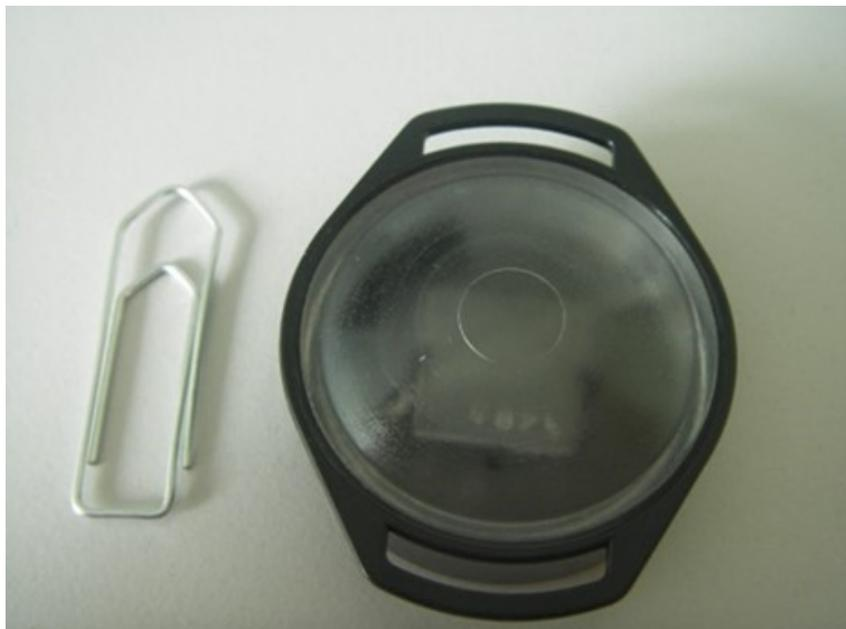
**Abbildung 7: Exposimeter mit Kernspurdetektor.**
