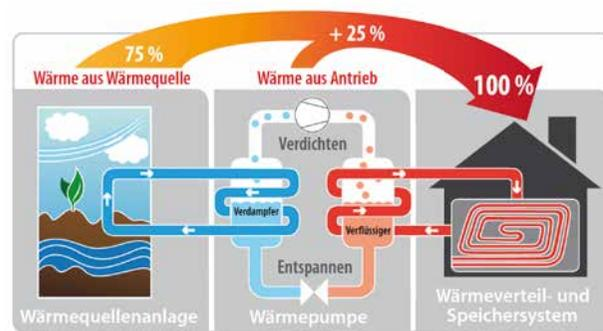
**i** Effiziente Wärmepumpen haben eine Jahresarbeitszahl (JAZ) von 4,0 bis 5,0. Sie führen etwa viermal mehr Umweltwärme in das Haus ab, als sie an Strom verbrauchen.
