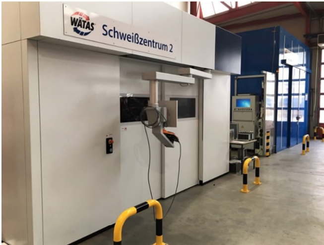
WätaS-Schweißzentren für das robotergestützte Laserschweißen. (Quelle: WätaS)
