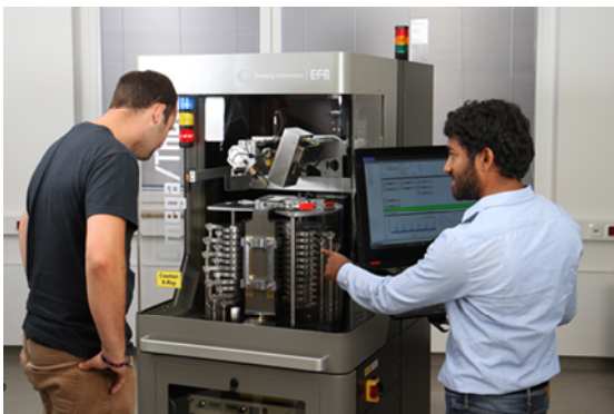
Omega/Theta Diffraktometer: Halbleitermesstechnik zur industriemäßigen Orientierung von Einkristallen. (Quelle: Freiberg Instruments)
