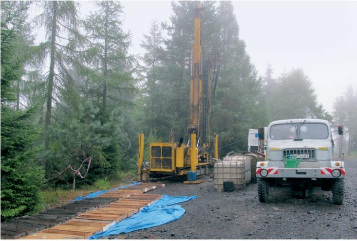
Abb. 2-8: Im Hintergrund ist das gelbe Bohrgerät aufgebaut, im Vordergrund liegen in Kernkisten aufbewahrt die erbohrten Kerne. Foto: Š. Mrázová, 2018.
