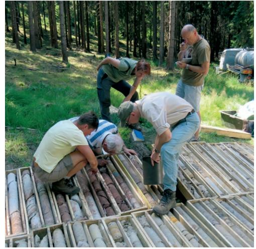
Abb. 2-9a: Geologische Dokumentation von Bohrkernen. Foto: P. Rambousek, 2018.
