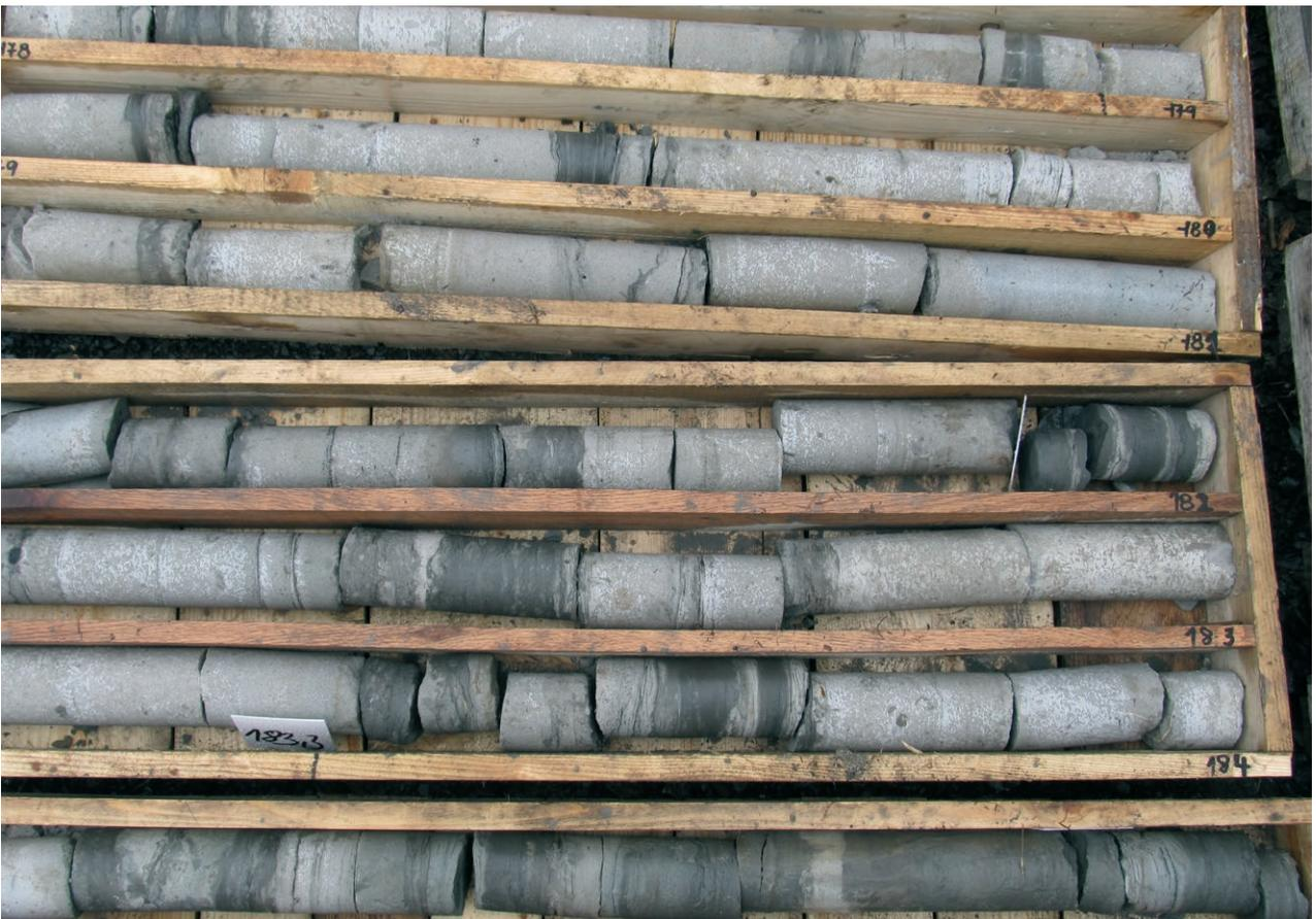
Abb. 2-9b: Detailfoto von aufgereihten Bohrkernen in Bohrkernkisten. Foto: Š. Mrázová, 2018.
