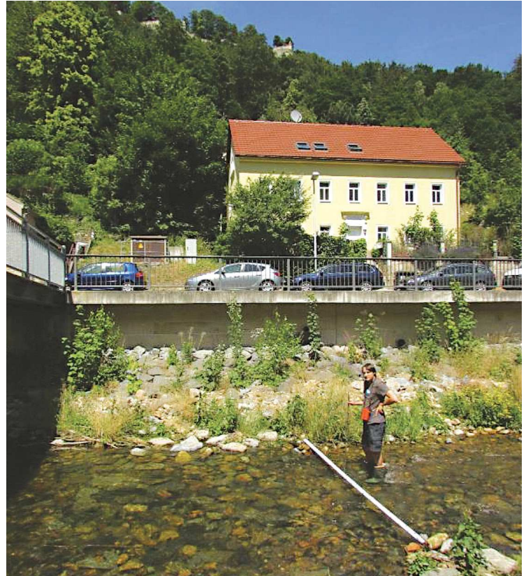
Abb. 3-12: Das unterste mit einer Messlatte eingemessene Profil im Bach Biela, ca. 1700 m vor der Mündung in die Elbe. Es wurde ein Abfluss von 275 l/s ermittelt.
