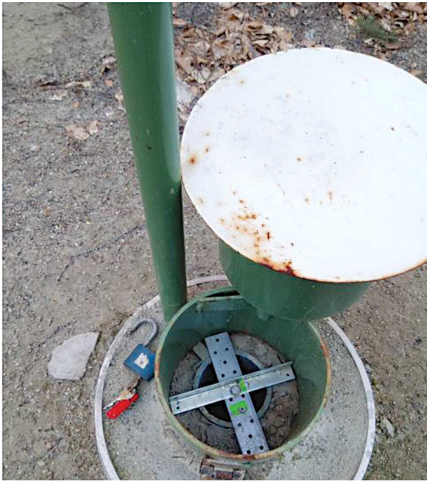
Abb. 3-4: Blick in das unverschlossene Standrohr der Grundwassermessstelle RE001 bei Sněžník zur Aufzeichnung des Grundwasserspiegels.
