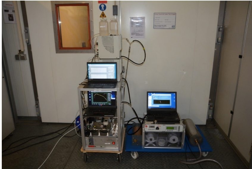
Abbildung 6: Foto vom Aufbau der Aerosolmesstechnik. Mobilitäts-Partikelgrößenspektrometer und die beiden Gesamtpartikelzähler (T-CPC 1&2) auf der linken Seite und der Rußmonitor auf der rechten Seite. Im Hintergrund ist die Flügeltür zur Klimakammer. Foto: K. Weinhold (TROPOS)
