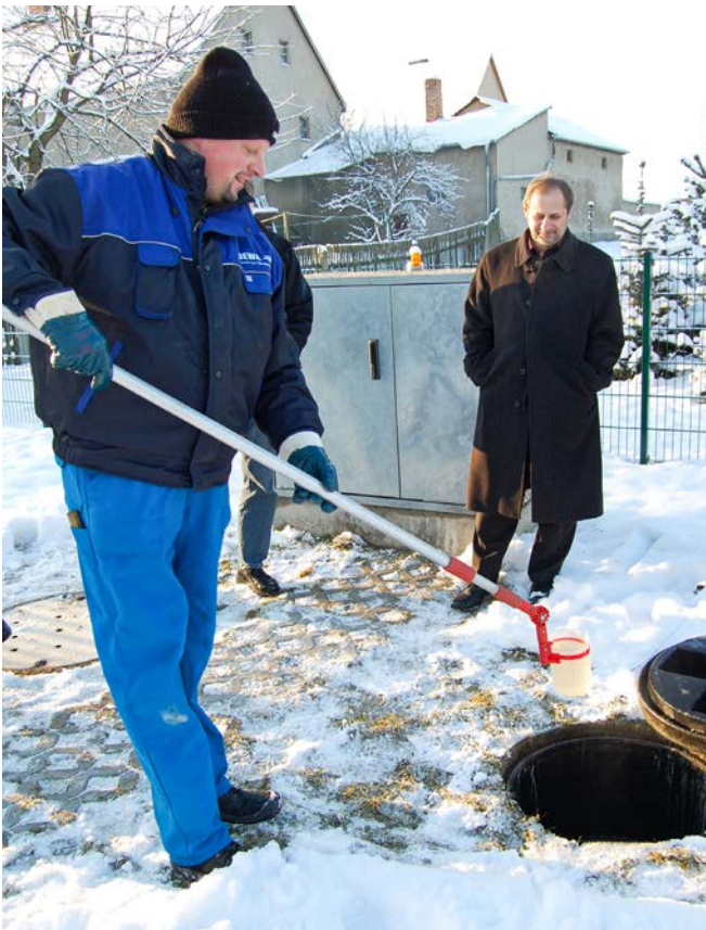
Abwasserprobenahme an einer öffentlichen Gruppenkläranlage in Frohburg, Ortsteil Frauendorf (Kapazität: 50 EW) Aufgabenträger: Versorgungsverband Grimma-Geithain (VVG) Betriebsführer: Veolia Wasser Deutschland GmbH
