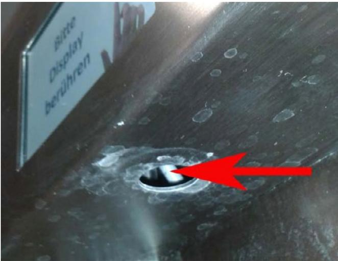
Abbildung 2: Auslassöffnung mit offenem Auslauf (mögliche Probenahmestelle für Abstrich)
