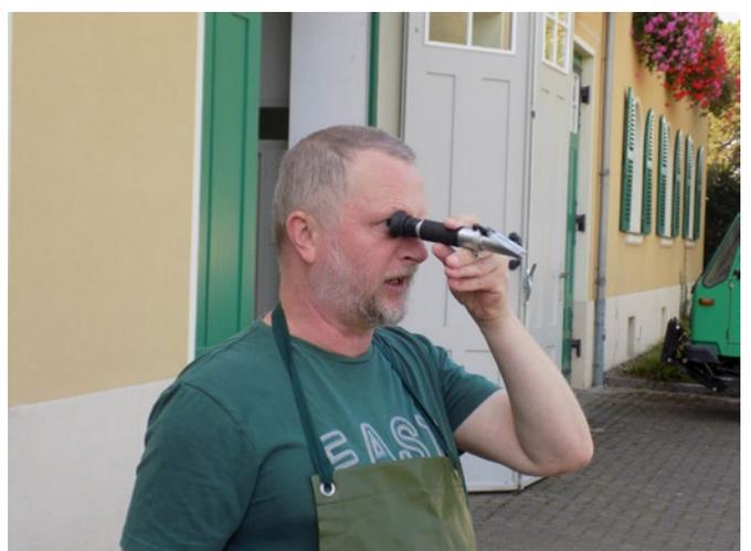
Abbildung 6: Bestimmung der Mostgewichtes mittels Handrefraktometer
