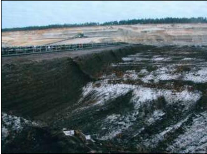
**Abb. 7.40:** Gewinnung der Oberbank des 1. MFK im Braunkohlentagebau Nochten; im Liegenden helle Sande der Klettwitz-Schichten; im Hintergrund Flaschentonhorizonte der Mühlrose-Schichten (Foto: H. Domko, Cottbus; aus AUTORENKOLLEKTIV 2010).
