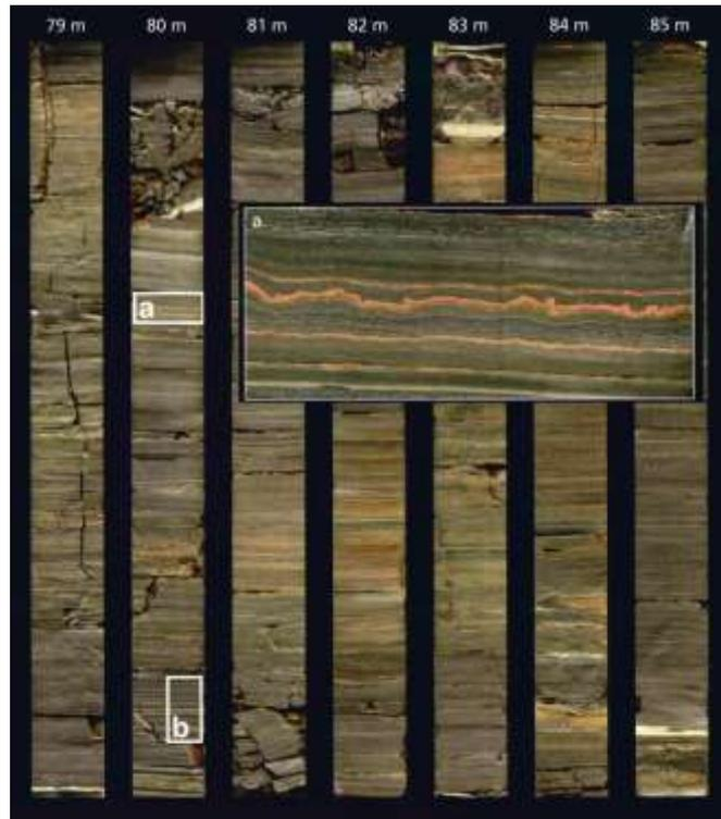
**Abb. 7.17:** Feinlaminiertes Diatomit der Kleinsaubernitzer Schichten (geschichtete Diatremfazies des Maars von Baruth) in der Forschungsbohrung Baruth 1/1998; kleines Foto: Wechsellagerung von Diatomiten, Turbiditen und Sideritlagen (Fotos aus GOTH & SUHR 2007).
