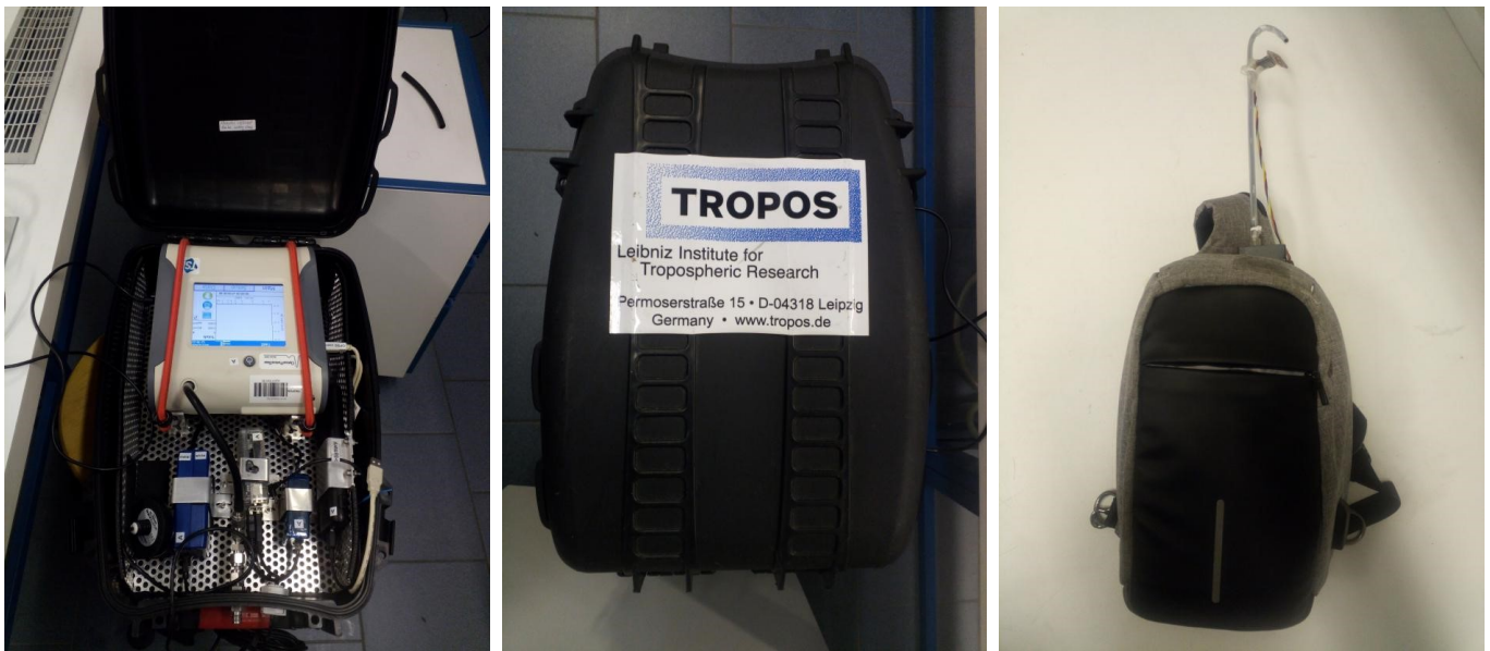
Abbildung 4: Mobile Messrucksäcke des TROPOS (links/Mitte: Messrucksack mit OPS-3330 und Aethalometer AE-51, rechts: miniaturisierter Messrucksack mit PM 10 -Sensor, meteorologischen Sensoren und Aethalometer MA-200. Für die Messungen wurden beide Rucksäcke parallel eingesetzt.
