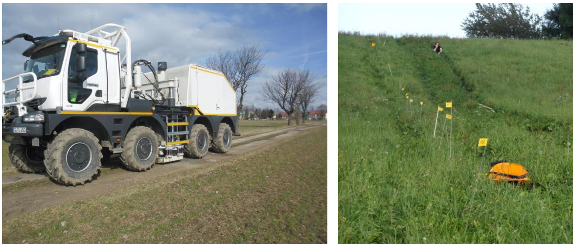
Obr. 10: Použité vibroseis vozidlo univerzity TU Bergakademie Freiberg a přehled použitých snímajících geofonů.
