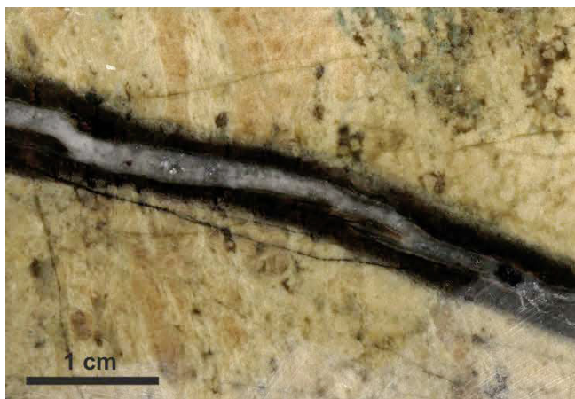
Abb. 2-23: Epidot-Granatfels mit schwarzem und grauem zinnführendem Quarz-Trüm (0,20 % Sn). Ehrenfriedersdorf, 3. Sohle (Westfeld)
