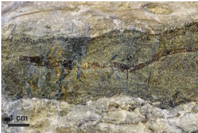
Abb. 5-29: Beispiel für die Verskarnung von Marmor entlang von Bruchstrukturen: Umwandlung in graugrünen Pyroxenfels mit feinem Lagengefüge und mittigem sulfidführenden Trum mit Zinn-, Kupfer-, Zink- und Arsenmineralisation sowie Spuren vom Malayait. Ehrenfriedersdorf, 3. Sohle (Westfeld)
