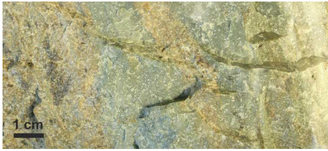
Abb. 2-5: Granat-Pyroxenfels, durch Verskarnung aus Marmorgebildet. Ehrenfriedersdorf, 3. Sohle (Westfeld)
