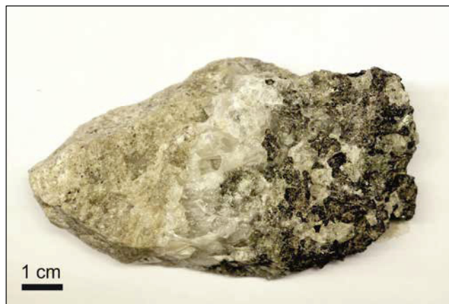
Abb. 2-24: Kassiterit-Quarz-Reicherzschlieren mit grobkörnigem dunkelbraunem Kassiterit, randlich hellgrauer grobkristalliner Quarz mit feinem grünlichem Glimmer, Übergang in feinkörnigen kassiteritführenden Quarz, Ehrenfriedersdorf, 2. Gezeugstrecke, Leimgrübler West
