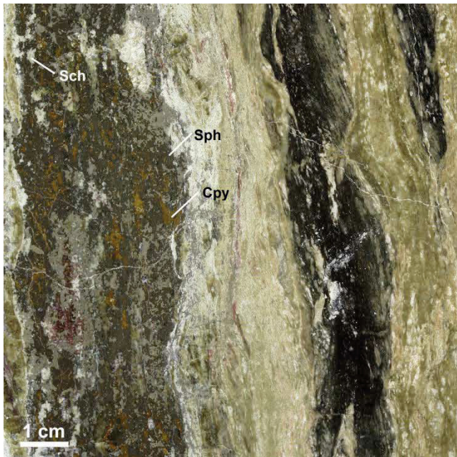
Abb. 2-28: Sulfidskarn (Pyroxen-Granatfels) mit Sphalerit (Sph), Chalkopyrit (Cpy) und Spuren von Scheelit (Sch). Ehrenfriedersdorf, 5. Sohle (Westfeld)
