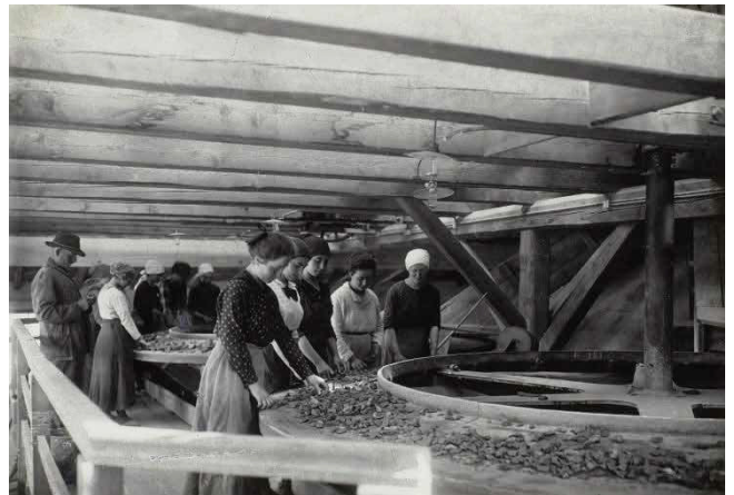
Abb. 2-18: Separation des Zinnerzes auf Klaubebühnen, Ehrenfriedersdorf um 1920 (Aufnahme von Arno Heinicke; Deutsche Fotothek)
