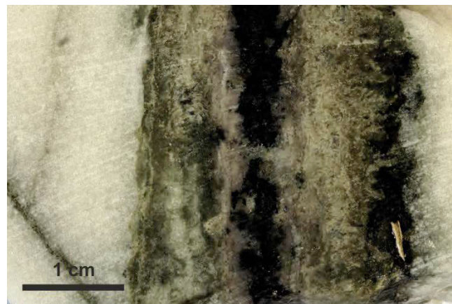
Abb. 2-4: Beginnende Verskarnung von Marmor entlang eines pneumatolytischen Trums, mit Spuren von Scheelit und Malayait, Ehrenfriedersdorf, 3. Sohle (Westfeld)
