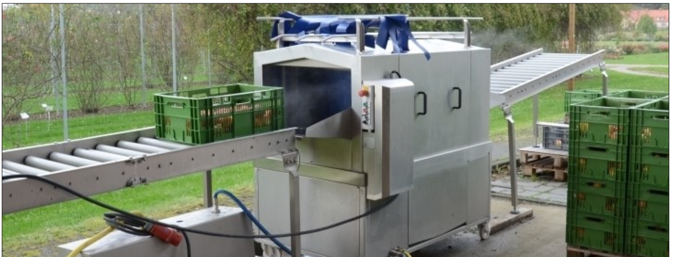
Abbildung 47: Gesamtansicht der mobilen Kistenwaschanlage. Hinten ist die Kistenzuführung zu sehen, links vorn eine gerade behandelte Kiste. Der Vorhang zur Abdichtung ist abgenommen.
