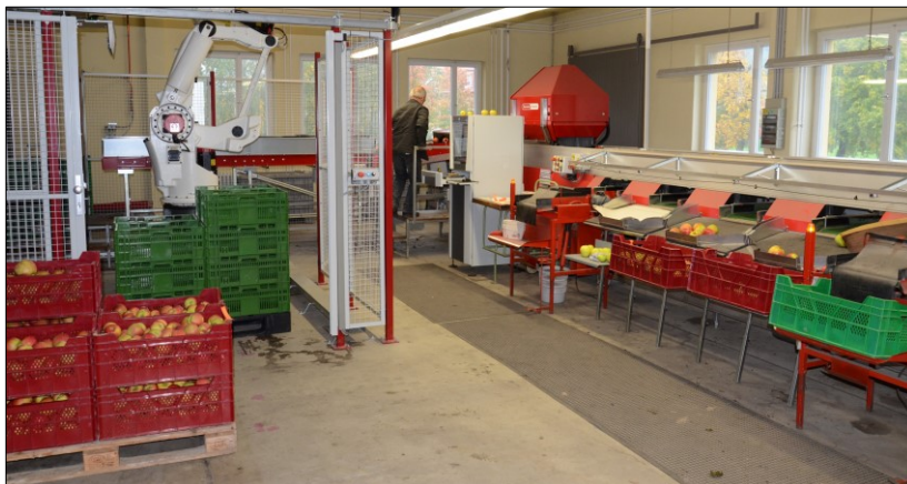
Abbildung 27: AWETA-Sortiermaschine in Dresden-Pillnitz, für Farb- und Größensortierung der Äpfel
