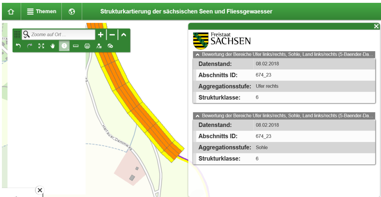
Abbildung 4: Screenshot der Ergebnisse der Gewässergütekartierung des Jahres 2016 der Lausitzer Neiße bei km 198 (s. Abb. 2) in 1-Band Darstellung (Gesamtbewertung, oben) und 5-Bänder Darstellung (unten): Flussbett, Ufer rechts /links, angrenzendes Gelände rechts/links. Gelb: “stark verändert”, orange: “sehr stark verändert”.
