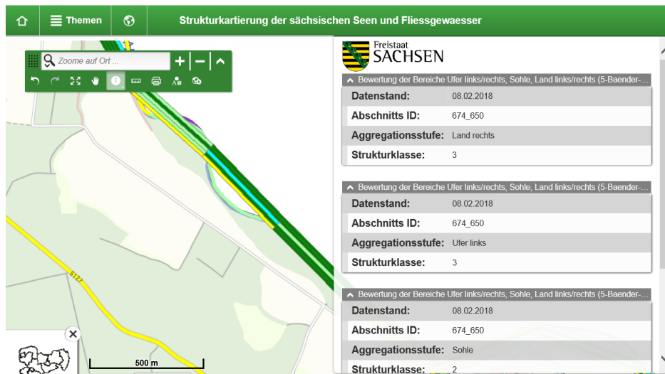
Abbildung 3: Screenshot der Ergebnisse der Gewässergütekartierung des Jahres 2016 der Lausitzer Neiße bei km 90 (s. Abb. 1) in 1-Band Darstellung (Gesamtbewertung, oben) und 5-Bänder Darstellung (unten): Flussbett, Ufer rechts/links, angrenzendes Gelände rechts/links. Blau: "gering verändert", dunkelgrün: "moderat verändert", hellgrün: "deutlich verändert", gelb: "stark verändert".
