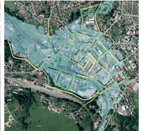
Typische Schadensbilder und Darstellung der Verletzbarkeit an Straßenverkehrsinfrastrukturen im potentiellen Überflutungsbereich der Smědá bei Frýdlant
