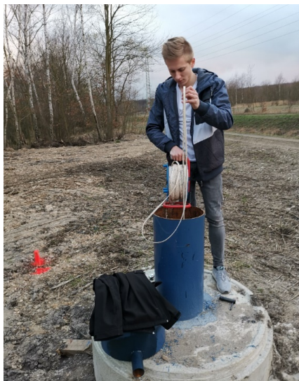
Abbildung 7-3: Tiefenmessung des Grundwasserspiegels in der Bohrung. Foto: VŠB – Technische Universität Ostrava.
