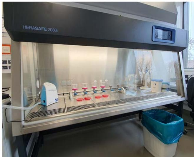
Abbildung 3: Ansatz der Spüllösungen mit einer Filtrationsanlage (4 Filtrationsplätze) in der Sicherheitswerkbank (links die Vakuumpumpe)
