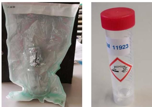
Abbildung 1: Probengefäße für mikrobiologische Untersuchung (links) (außen und innen steril) sowie für Bestimmung der Schwermetalle (mit vorgelegter Säure)
