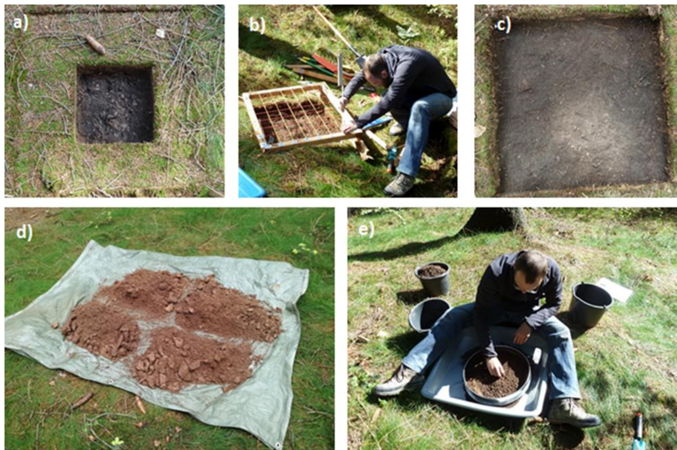
Abbildung 19: Methode der Profilbeprobung in skelettreichen Böden (ICOS Standort Tharandt). (a) Einmessen der Geländeoberkante und der Horizontgrenzen mit Hilfe des Messrahmens (b, c) Aufteilen des gewogenen Aushubs eines Horizontes in Aliquote (d) Sieben zweier Aliquote pro Horizont (e) Beprobung der organischen Auflage mittels Stechrahmens; Fotos: C. Schmidt-Cotta
