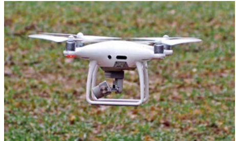
Abb. 3: Für diese Untersuchung verwendetes UAV (Typ: DJI™ PHANTOM™ 4 Pro) Foto: C. Gerber
