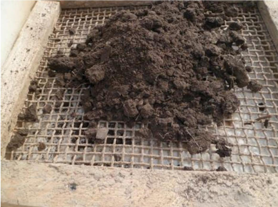
**Abbildung 1: Ungemischte Bodenprobe auf dem Bodensieb**
