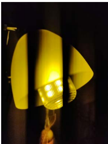
Abbildung 3: Flimmertest einer LED-Lampe mittels Handykamera (Bildquelle: LUA Sachsen)
