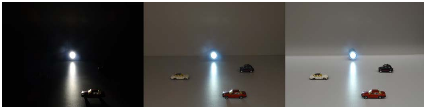
Abbildung 4: Wahrnehmung verschiedener Objekte bei Blendung und unterschiedlicher Umgebungshelligkeit (Bildquelle: LUA Sachsen)
