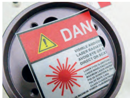
3.1.3 / Abb. 2: Warnhinweise auf einem Lasermodul, halb abgeschnitten
