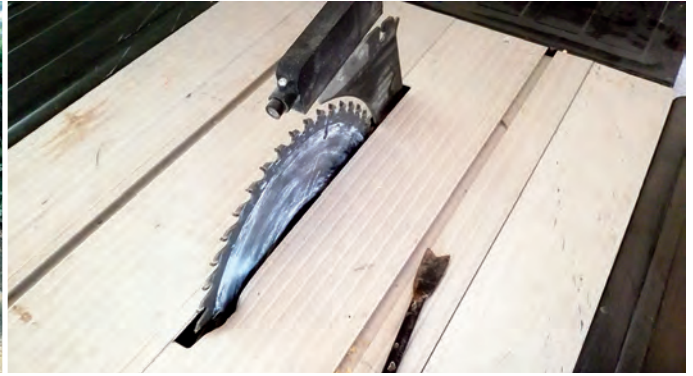
2.2.3 / Abb. 2: Kreissäge ohne Sägeblattschutzhaube; Schiebestock aus Metall (wurde behoben)
