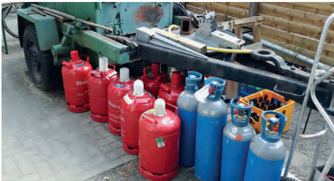
2.2.3 / Abb. 3: Ungesicherte Lagerung von Druckgasflaschen neben einer Feldküche (inzwischen wurde eine verschließbare Aufbewahrungsbox angeschafft)
