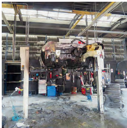
2.3.1 / Abb. 1: Ausgebrannte Fahrzeugkarosse nach Arbeiten am Kraftstoffsystem
