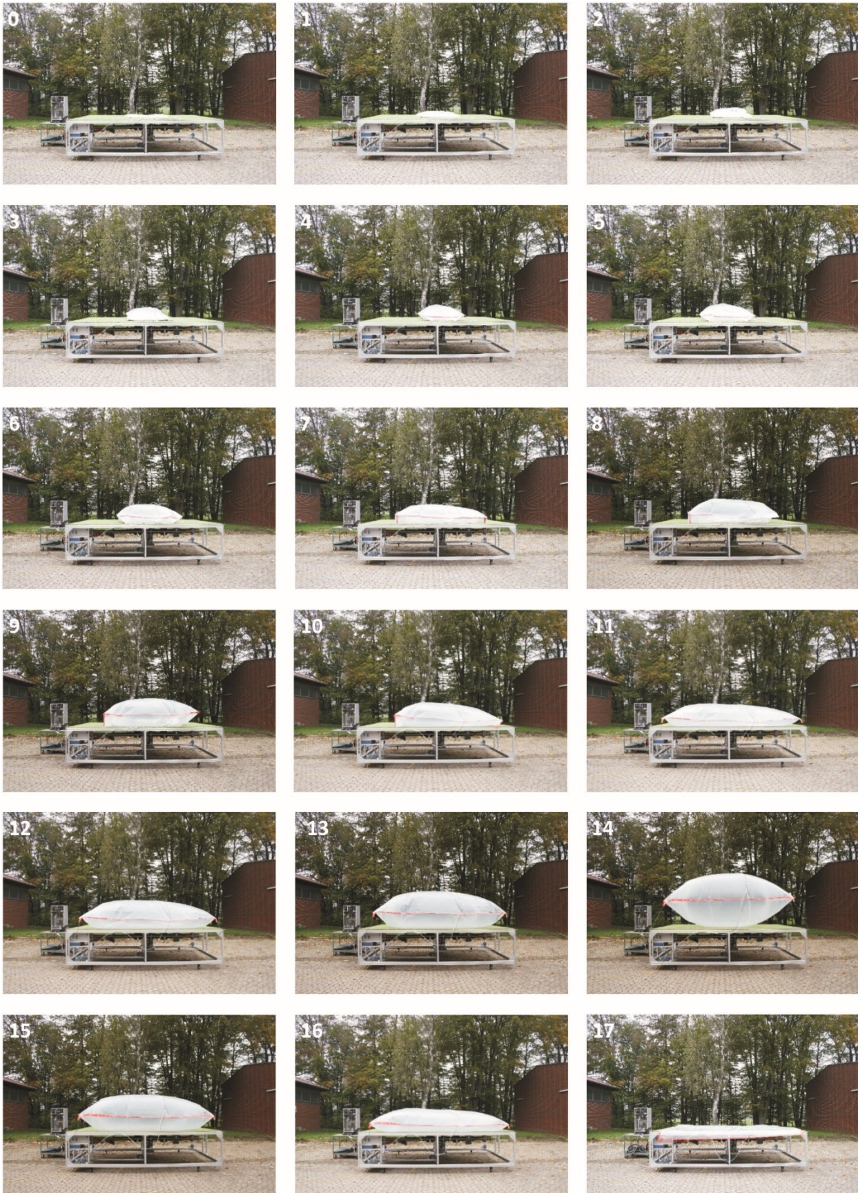
Abbildung 8: Versuchsdurchlauf mit einer 8 m 3 großen Kammer, minütlich fotografiert. Von t1 – t2 zudosieren des Testbioaerosols, von t14 – t15 Probenahme
