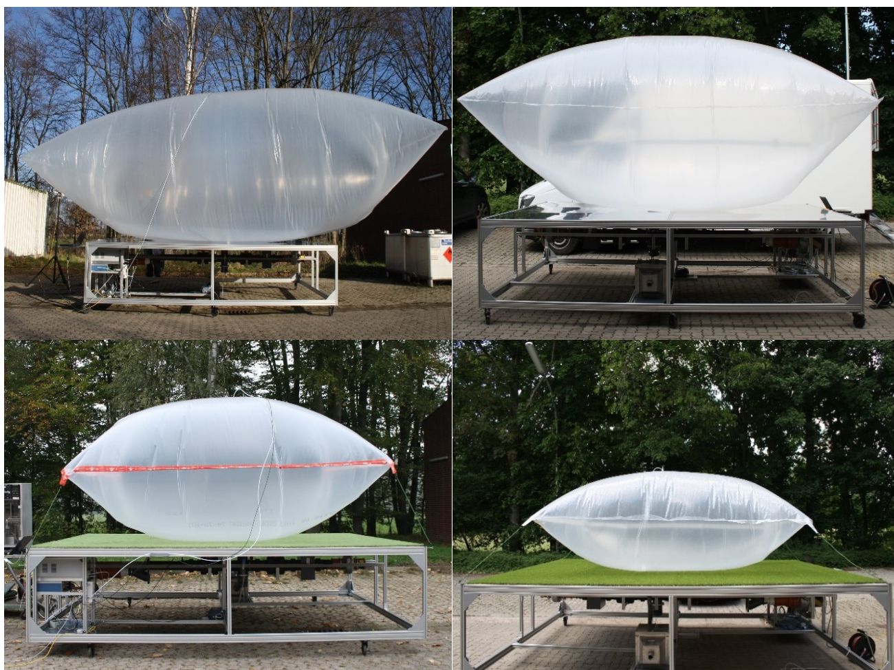
Abbildung 3: Unterschiedliche Größen der Bioaerosolkammern, jeweils voll aufgeblasen. Von oben rechts nach unten links: A: 37,8 m 3 , B: 16,1 m 3 , C: 8 m 3 , D: 2,9 m 3 .
