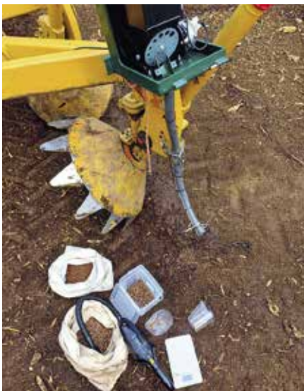
Bild 2: Material und Werkzeuge: Am TTS-Gerät für Bodenvorarbeiten ist eine Sämaschine angebracht, die unterschiedliche Nadel- und Laubholzsamen ausbringt. Foto: Enrico Jassmann
