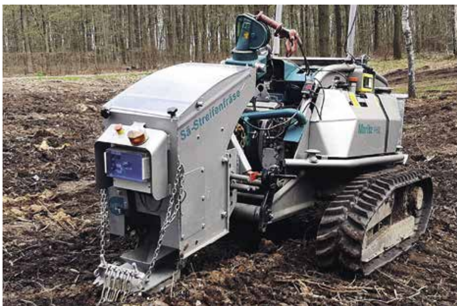
Bild 1: Moritzraupe mit Eichelsämaschine. Die Kombination aus kleinem Bänderlaufwerk und angebaute Legevorrichtung ist besonders bodenschonend und auch zur Vorausverjüngung geeignet. Foto: Enrico Jassmann
