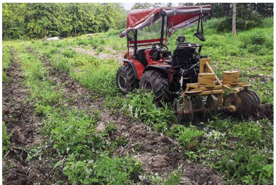
Bild 4: Kulturpflege mit dem Kleintraktor. Zum Schutz der Sämlinge gegen Konkurrenzvegetation werden die Saatreihen mit einer speziellen Scheibenegge zwischen die Räder genommen. Foto Enrico Jassmann
