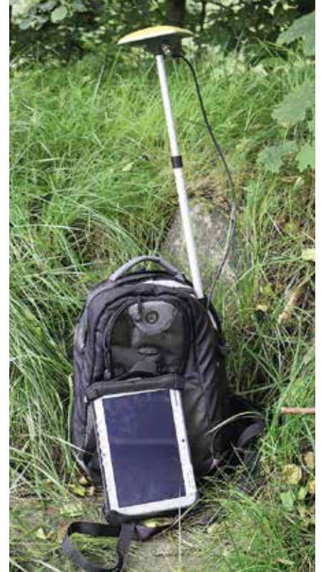
Abb. 4: GPS-Vermessungsgeräte zur Grenzfindung bei der Beratung der Privatwaldbesitzenden; Foto: Mirjam Oeser
