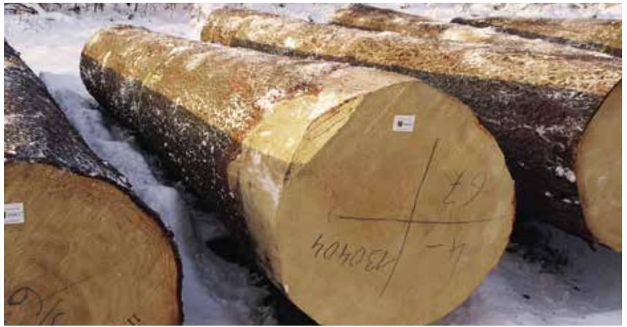
Abb. 2: Perfekt ausgehaltene Fichte; Länge, Durchmesser und Stammnummer angeschrieben, Wurzelanläufe beigeschnitten, Mitte markiert; Foto: Hendrik Scholz
