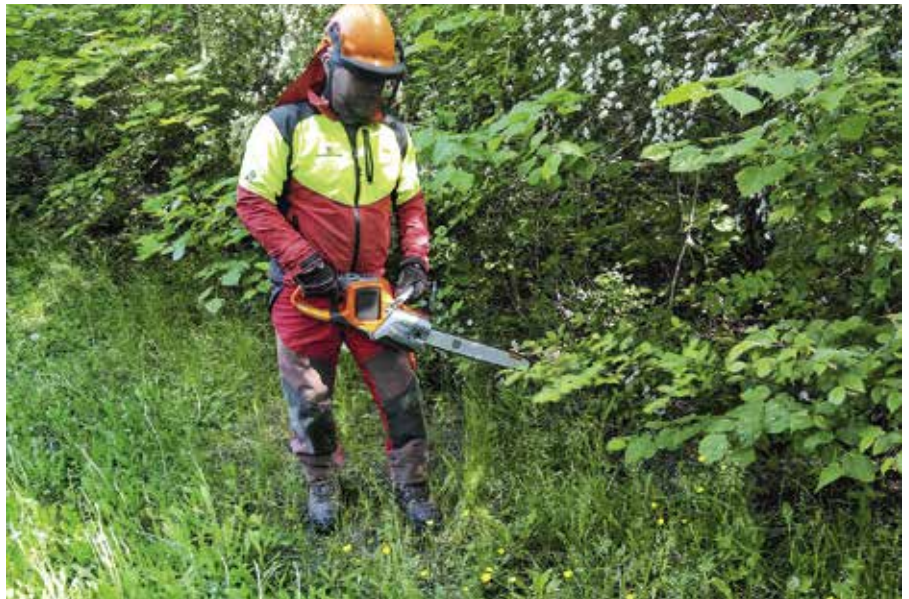
Abb. 2: Schutzausrüstung für die Arbeit mit der Kettensäge; Foto: Falk Germann
