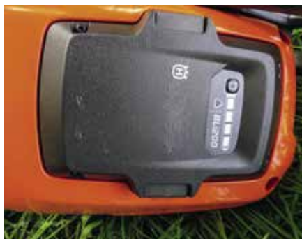
Abb. 1: Wechselakku in einer Kettensäge; Foto: Falk Germann
