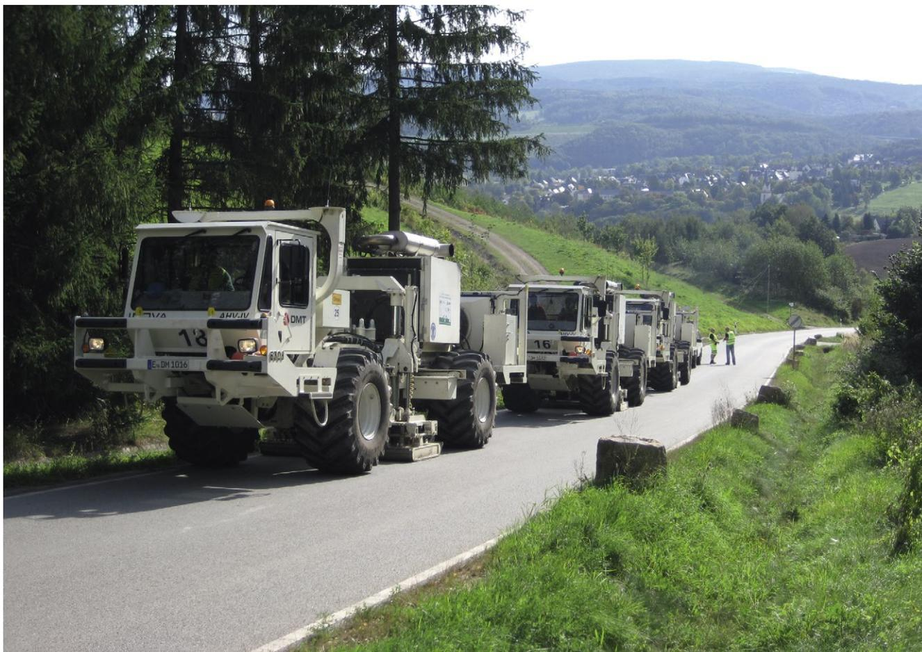
Abb. 8: Vibrationsfahrzeuge zur seismischen Vermessung des Untergrundes im Raum Schneeberg (E. Lüschen)
