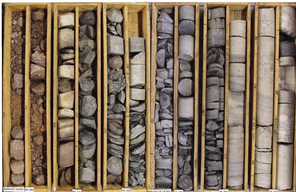
Abb. 5: Gesteinsbohrkerne, hier aus Oelsnitz. Sie wurden erbohrt, um Kenntnisse zur Hydrogeologie zu gewinnen. Auf dem Foto befindet sich eine wissenschaftlich höchst bedeutende Abfolge mit vulkanischen Gläsern.
