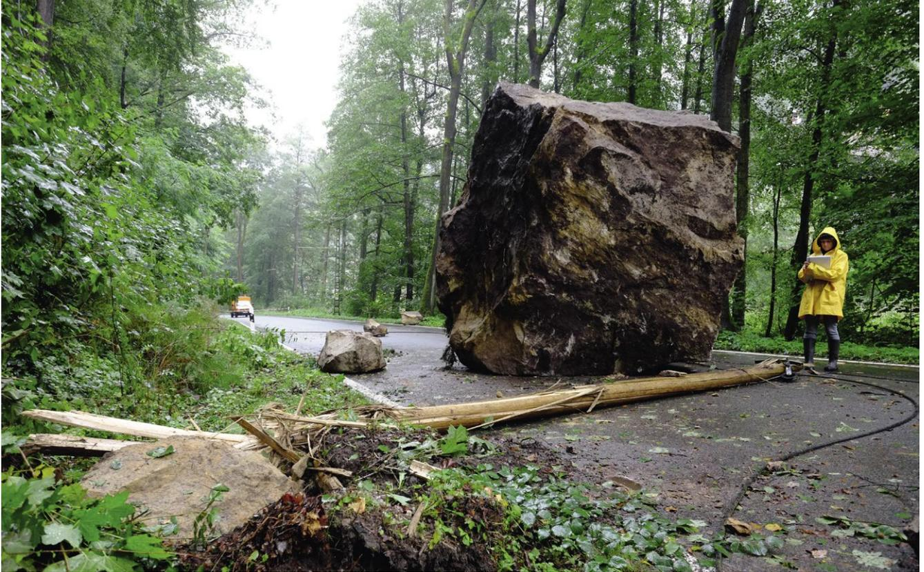
Abb. 1: Mitarbeiterin des Staatlichen Geologischen Dienstes in Sachsen bei der Erfassung eines Felssturzes am 02.09.2014 im Kirnitzschtal. Der Felsblock hatte ein Volumen von 36 m<sup>3</sup>. Insgesamt kam es bei dem Ereignis zum Absturz von etwa 120 m<sup>3</sup> Sandsteinmaterial (LfULG/ Starke)
