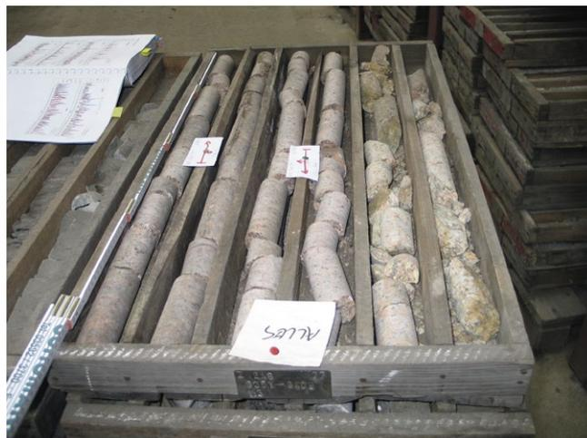
Abb. 13: Bohrkerne einer WISMUT-Bohrung mit Kennzeichnung der mittels mobiler RFA untersuchten Bereiche
