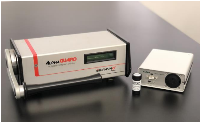
Abbildung 1: Messgeräte zur Bestimmung der Radonaktivitätskonzentration in der Raumluft (Saphymo (jetzt Berlin) AlphaGUARD, ALTRAC Typ LD, SARAD Radon Scout, von links nach rechts)
