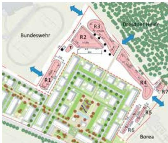
Plan des Ersatzlebensraums (ELR), dessen Bild durch 3 – 4 m hohe Wälle (R 1–R 7) geprägt wird. Durch einen Stabmattenzaun mit Betonsockel (rote, gestrichelte Linie) wird der ELR zum zukünftigen Wohngebiet abgegrenzt. T: ehemaliges Freilandterrarium, ● solitärer Baumstube. Die blauen Pfeile zeigen potentielle Migrationsrichtungen an. Grafik: J. Plötner
