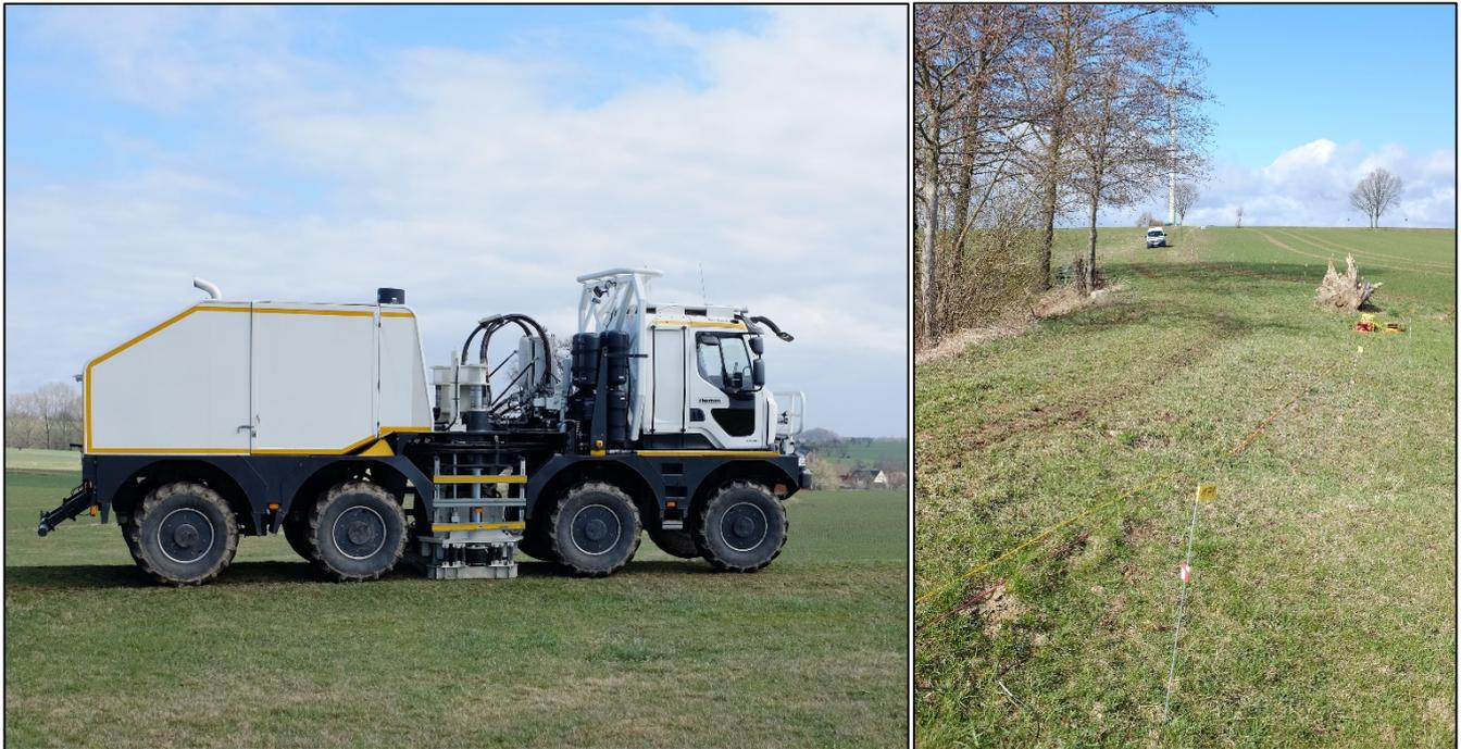
**Abbildung 12: Links – Vibroseis-Fahrzeug mit abgesenkter Bodenplatte. Rechts – Ansicht Empfänger Aufbau, Blick vom Teich nach Norden in Richtung Windrad.**
