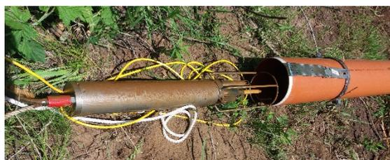
Abb. 15: Multiparametersonde Spreewitz beim Einbau.
