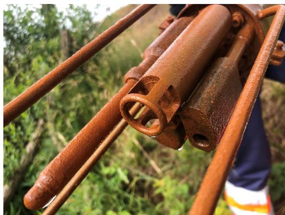
Abb. 16: Eisenablagerung auf der Sonde nach einer Woche Einsatz.
