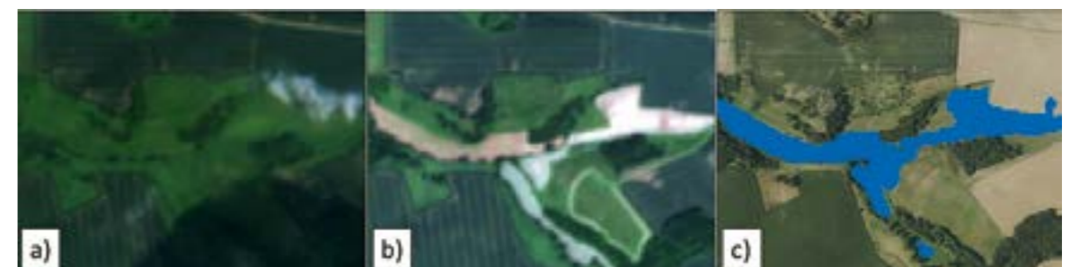
Abb. 5: Mahddetektion mithilfe von Sentinel-2-Satellitendaten. a) Aufnahme vom 07.06.2021 mit ungeernteten Feldern und Wiesen. b) Aufnahme vom 17.06.2021 mit einzelnen gemähten Wiesen (hellbraun). c) Über automatisierte Mahddetektion zum 17.06.2021 festgestellte Mahdereignisse (blau), Hintergrund: Luftbildaufnahme.
