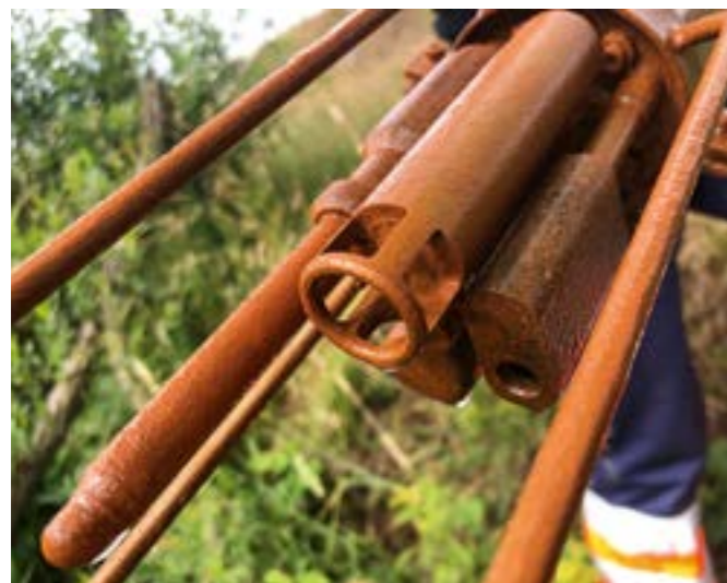
Abb. 14: Eisenablagerungen auf einer Multiparametersonde nach einer Einsatzzeit von 1 Woche in der Spree (Spreewitz)
