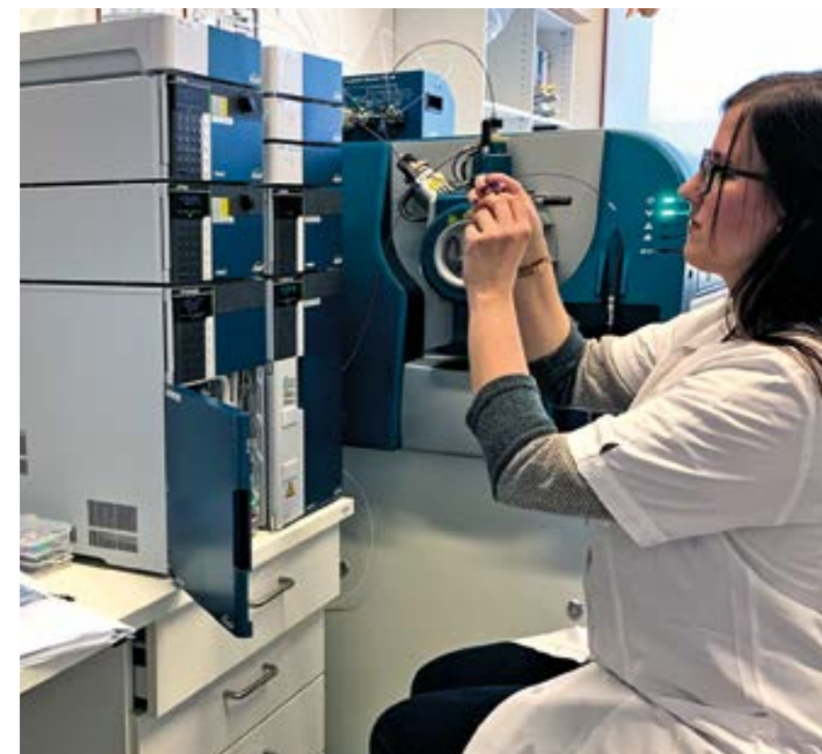
Abb. 3: Hochauflösendes Massenspektrometer für die organische Rückstandsanalytik
