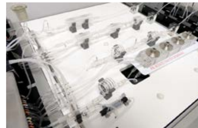
Abb. 8: Detailansicht CFA (Continuous Flow Analyzer) mit Dialysezelle
