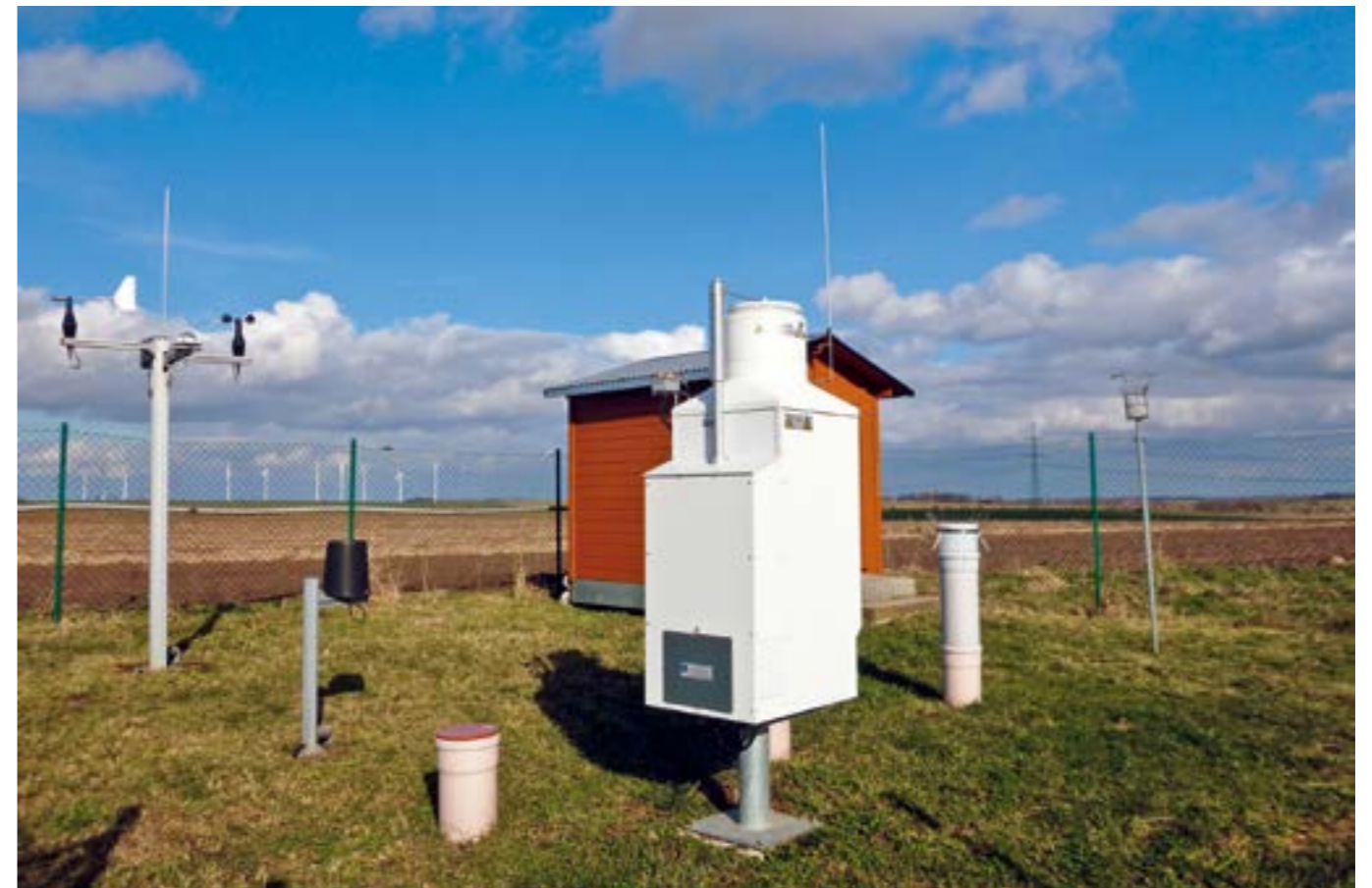
Abb. 7: Niederschlagssammler für nasse Deposition (wet-only) an der Station Köllitsch
