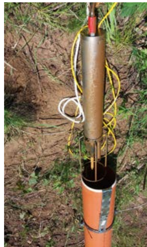
Abb. 13: Multiparametersonde beim Einbau
