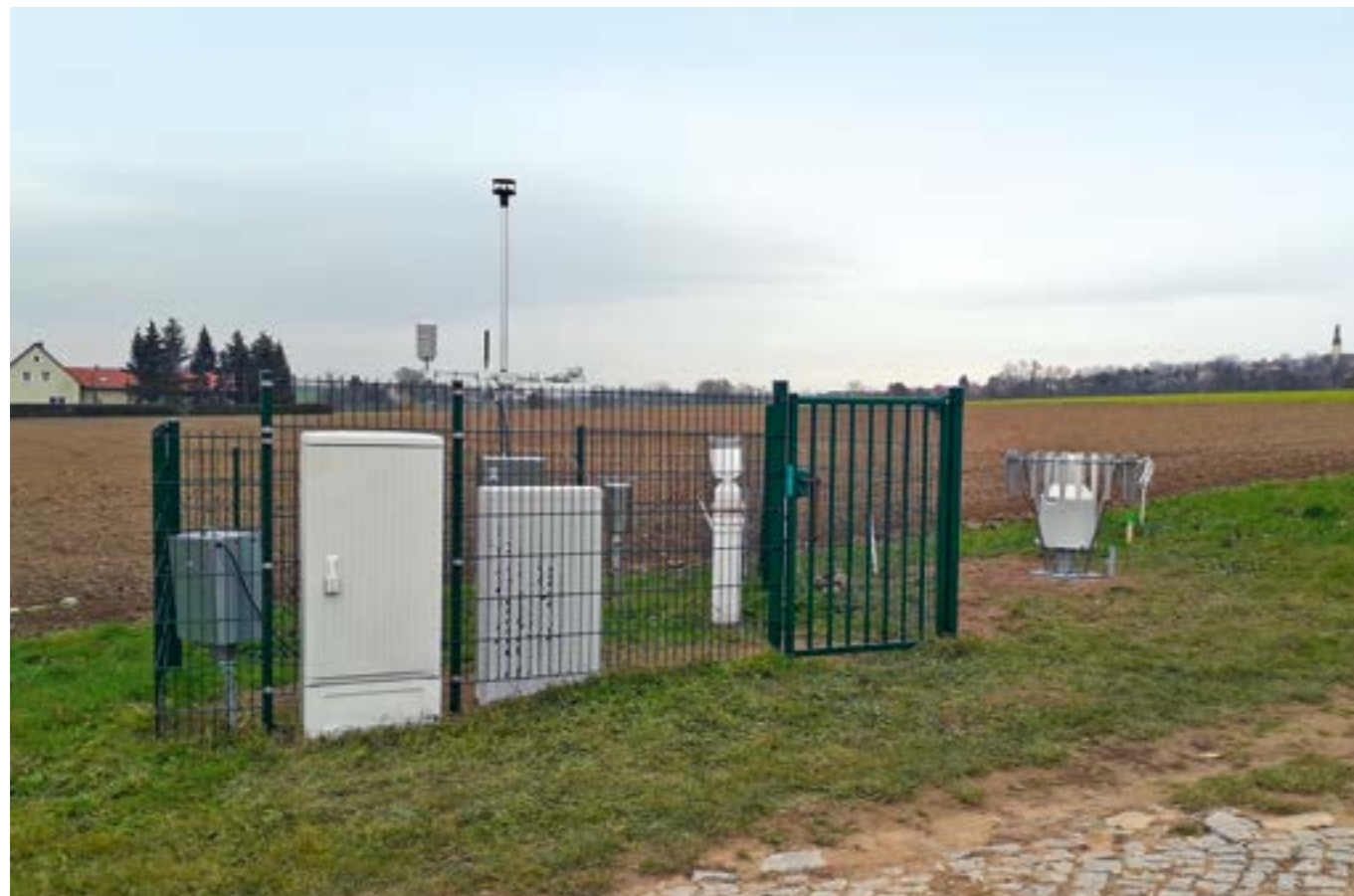
Abb. 9: Neues Ombrometer an der AMN Station Pommritz
