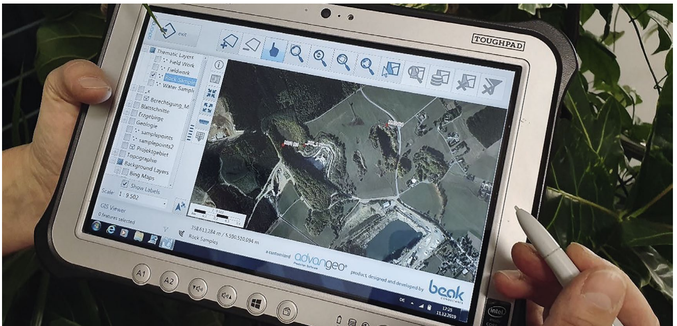
Abbildung 4: Tablet Computer mit Software zur Erfassung von Felddaten advangeo® fieldCap.
