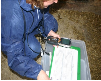
Abbildung 97: Messung der Stallrauminnenbeleuchtung mit dem Luxmeter
