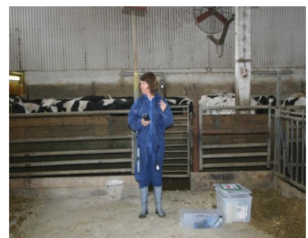
Abbildung 96: Messung der Luftgeschwindigkeit mit dem Anemometer
