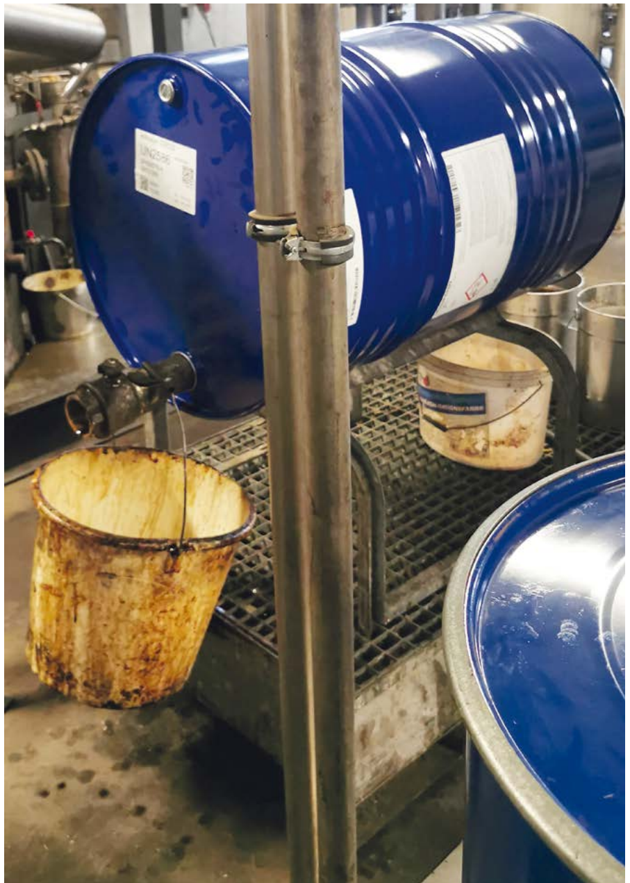
2.2.2 / Abb. 2: Gefahrstoffe als Verschmutzungen auf Arbeitsmitteln und Fußboden
