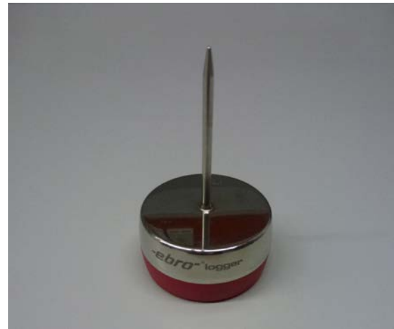
Abbildung 3: Temperatur-Datenlogger vom Typ EBI 10-T230 der Firma xylem/ Ebro
