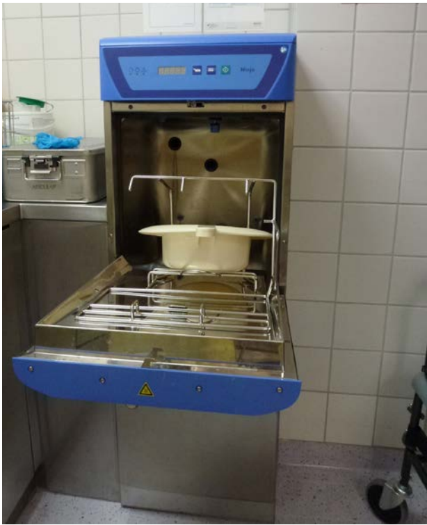
Abbildung 2: Reinigungs- und Desinfektionsgerät für Steckbecken mit einem eingelegten Kunststoff-Steckbecken
