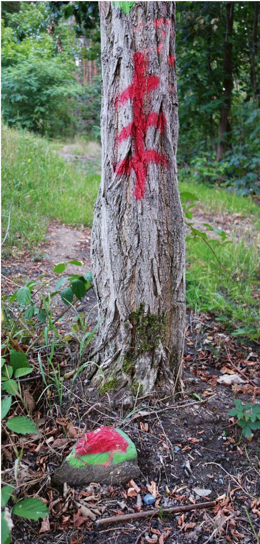
Abb. 3: Grenzpunkt in Form eines alten spitz behauenen Feldsteins (grün-rot markiert) mit Grenzzeichen (in Richtung Stein) an nahestehendem Baum; Foto: Markus Richter
