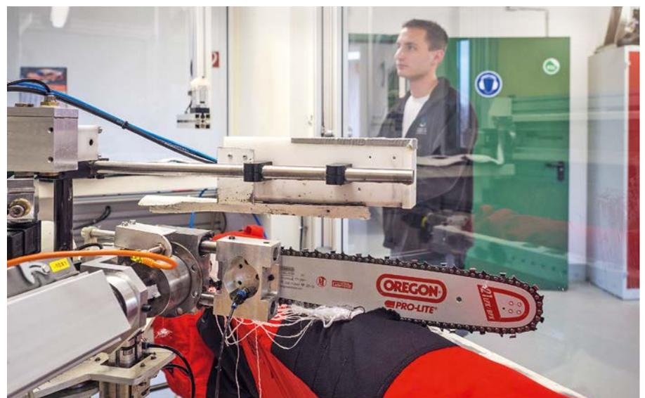
Abb. 1: Prüfung von Schnitzzuschutzkleidung an einem Prüfstand des KWF; Foto: KWF
