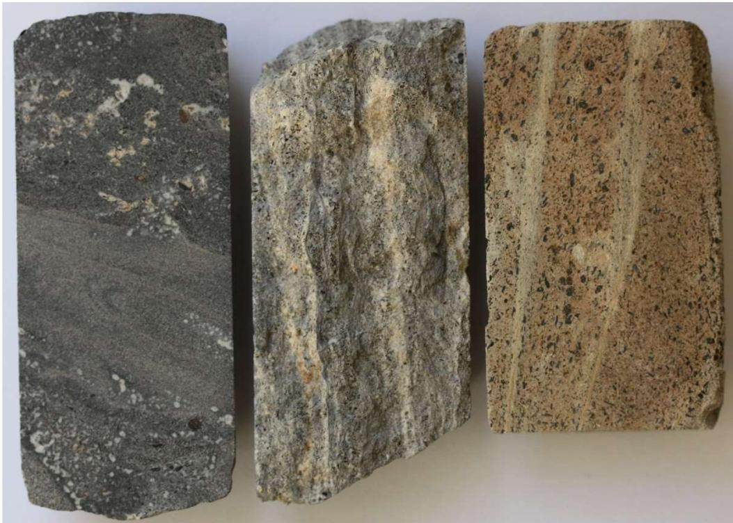
Abb. 6.2-14: Fotografische Aufnahmen von Phlogopit-Alvikiten mit Fluidaltextur (Bohrkernbreite: ca. 45 mm). Links: Wis GB 1477a/85, 905,0 m, Mitte: Wis GB 1477a/85, 899,6 m, Rechts: SER De 3/82, 407,8 m.
