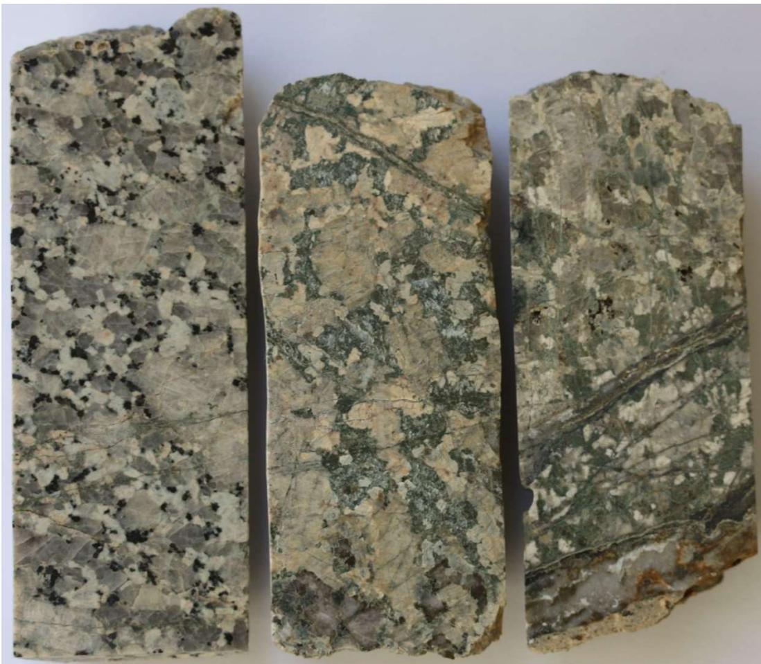
Abb. 6.3-6: Fotografische Aufnahmen von nicht fenitisiertem Granodiorit (links), mittelgradigem Na-Fenit (Mitte) und hochgradigem Na-Fenit (rechts). Die gezeigten Bohrkernstücke sind Xenolithe aus der beforsitischen Brekzie von Storkwitz. (Bohrkernbreite: ca. 45 mm). Links: SER De 6/82, 524,5 m, Mitte: SER De 6/82, 465,0 m, Rechts: SER De 6/82, 558,5 m.
