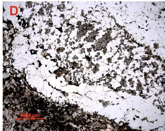
**D** - Dünnschliff vom Quarzfaltenkern der Quarz-Kassiteritlage, Cst II auf Faltenrissen und zwischen den Quarzkornzwickeln
