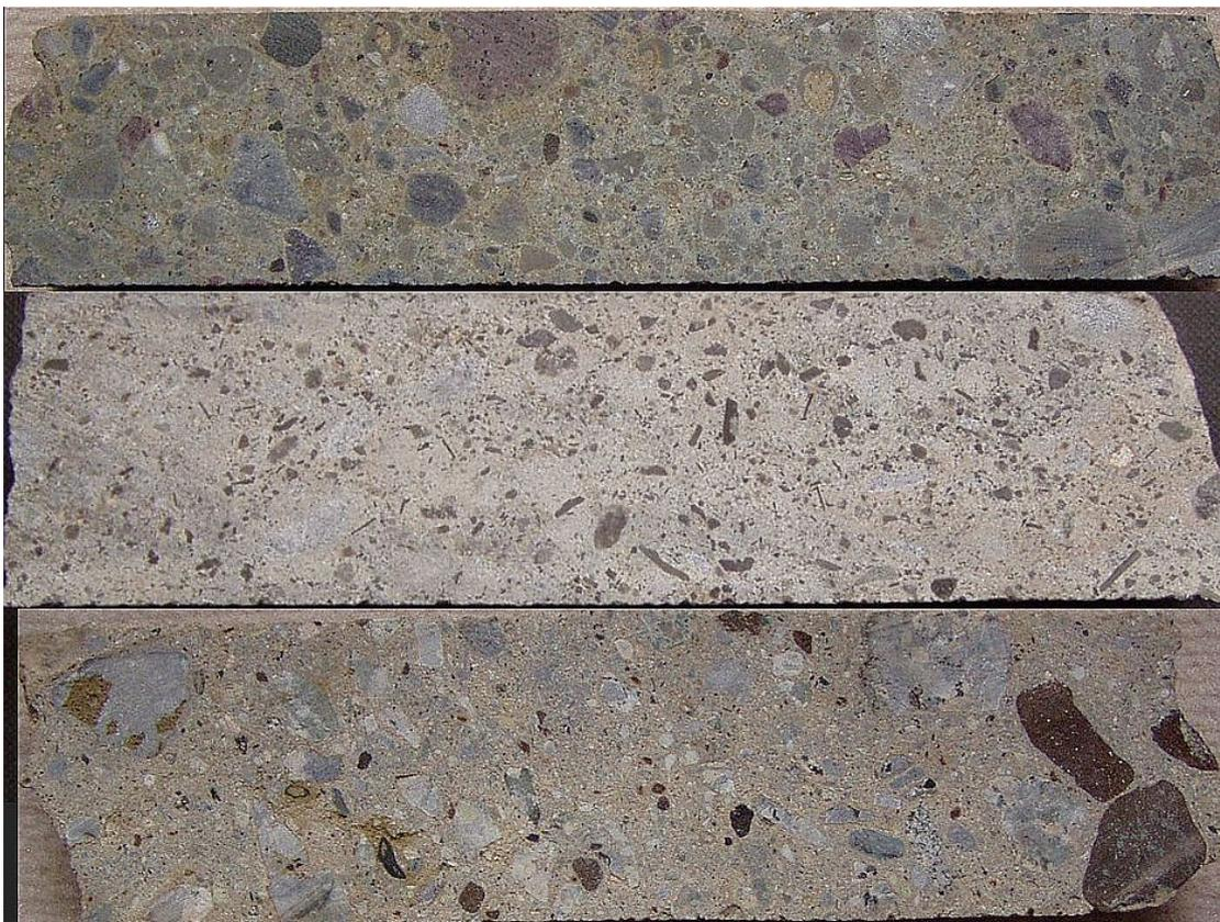
Abb. 6-4-2: Bohrkerne (Bohrkerndurchmesser 47 mm) der verschiedenen Diatrembrekzientypen, oben: autolithische UML-Brekzie, Wis BAW 562/76, 260,5 m, Mitte: alvikitische Eruptivbrekzie, Wis BAW 1340/79, 208,5 m, unten: beforsitische Brekzie, SER De 3/82, 453,6 m.
