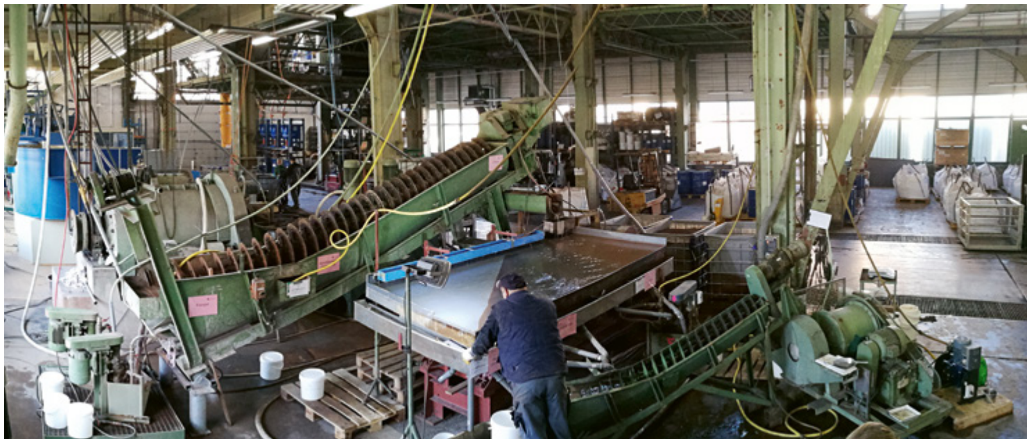
Abbildung 32: Pilotanlage zur Gewinnung von Sulfiden, Kassiterit und Magnetit aus einer Großprobe (Quelle: UVR-FIA GmbH 2018)
